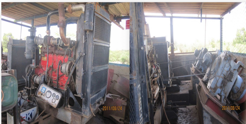
Figure 24 : Moteurs diesel couplés à des réducteurs de vitesses actionnant des hydro vis dans la Vallée du Sourou (Photo D. Kambou)
