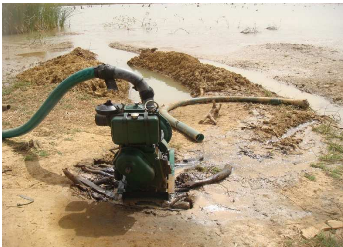
Figure 37 : Station de pompage sommairement installée sur le petit réservoir de Rassomdé . (Photo D. Kambou)
