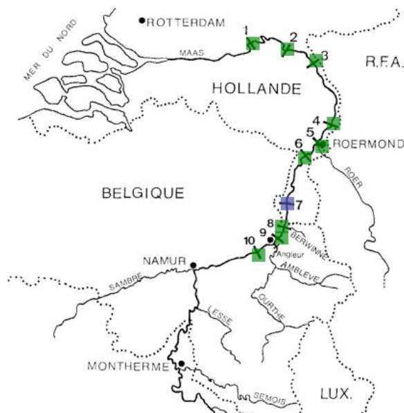
Figure 5/6. Carte de la Meuse montrant les 10 barrages, dont celui de Borgharen-Maastricht (en bleu), équipés de passes à poissons modernes permettant une libre remontée des salmonidés migrateurs.
