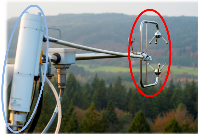
Figure 1-9 : Analyseur infrarouge (à gauche, entouré en bleu) et anémomètre sonique (à droite, entouré en rouge), les instruments à la base de la mesure de la Net Ecosystem Productivity . Vue du haut de la tour de Vielsalm vers le nord-est (Photographie : Jean-Louis Wertz)
