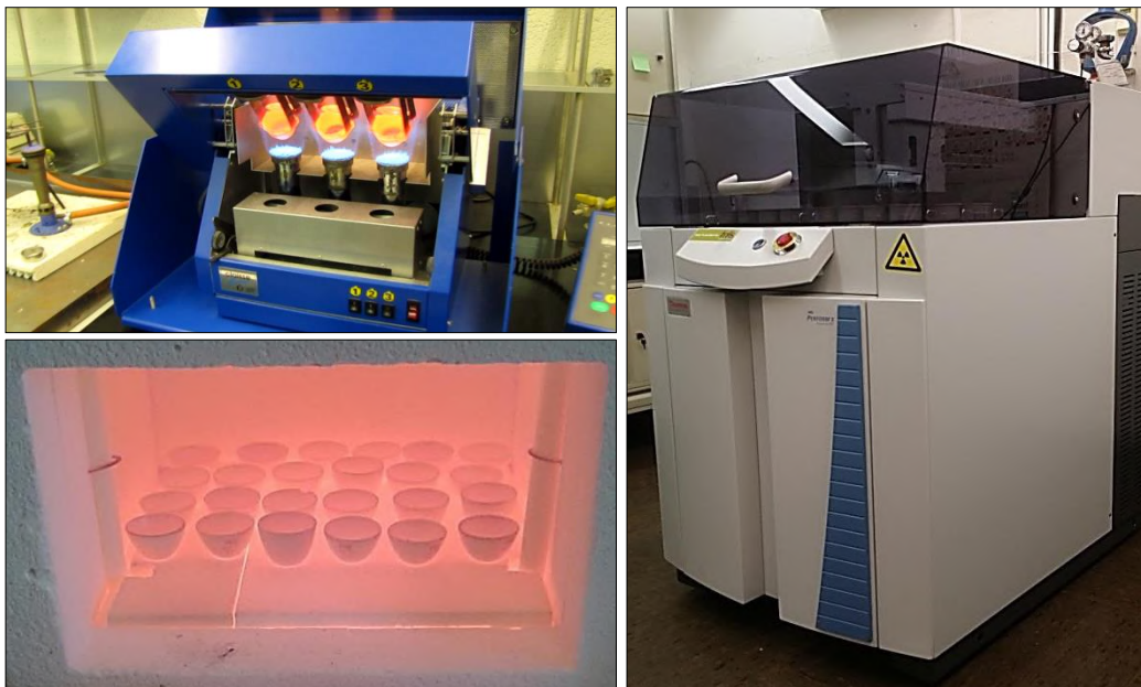
Figure. II.6: Appareil de fusion Claisse Fluxer M4 permettant d'obtenir des perles fondues (« Glass discs ») en haut à gauche. Calcination des échantillons dans un four de préchauffage (Nabertherm) à 1000°C en bas à gauche. À droite, l'instrument XRF ARL Perform-X 4200 utilisé pour les analyses géochimiques des éléments majeurs et traces.
