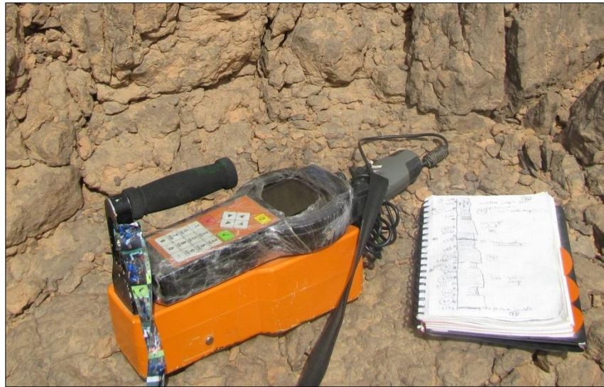
Figure. II.5: Susceptomètre gamma-ray portatif (GRS), permettant d'obtenir sur terrain les concentrations en potassium (K en %), uranium (eU en ppm), thorium (eTh en ppm), le débit de dose et les mesures des spectres de rayons gamma naturel en nanogray (« Dose Rate » en nGy h -1 ). Le GRS est couplé à un GPS afin de fournir les coordonnées géographiques de chaque mesure.
