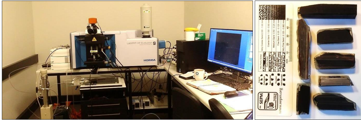
Figure. II.8: Spectromètre HORIBA (Jobin Yvon ®) LabRAM HR Evolution utilisé. À droite, exemple d'échantillons des black shales riche en graptolites étudiés.
