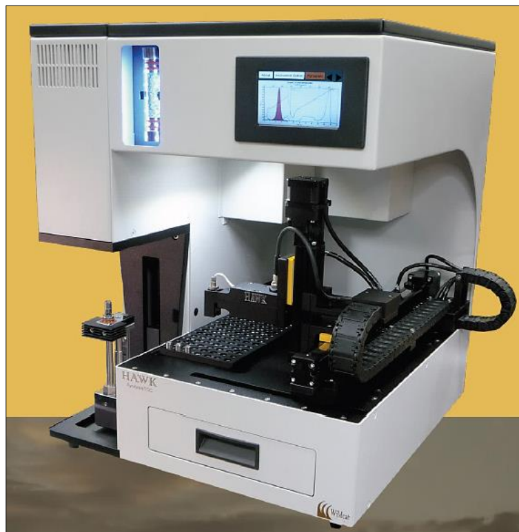
Figure. II.7: Instrument HAWK (Wildcat Technologies) utilisé pour la pyrolyse Rock-Eval. Il est capable de mesurer tous les paramètres de pyrolyse classiques ( S_1 , S_2 , S_3 , S_4 et T_{max} ) et de carbone organique total (COT ou « TOC »).
