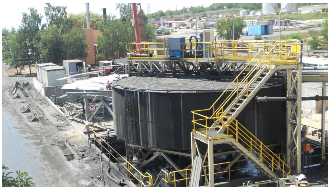
Figure 27 : photo du thickener de l'usine de Chelopech.
