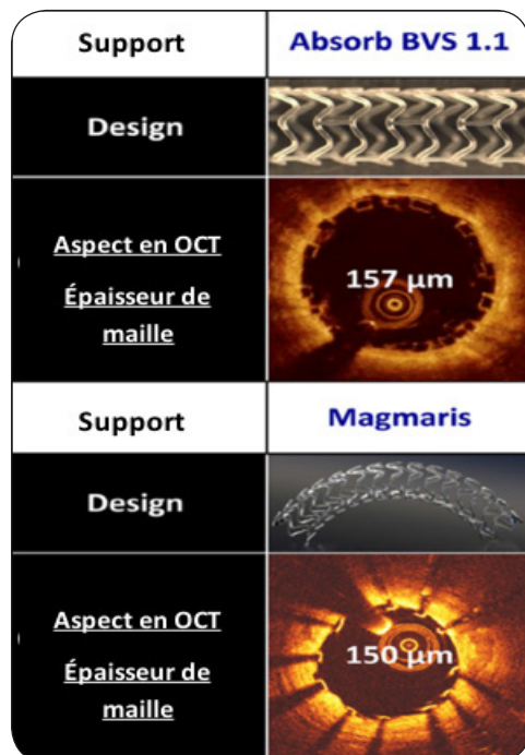
Figure 4. Stent biorésorbable de première et deuxième génération, comparaison des formats et de l'apparence des mailles en tomographie par cohérence optique (OCT).
