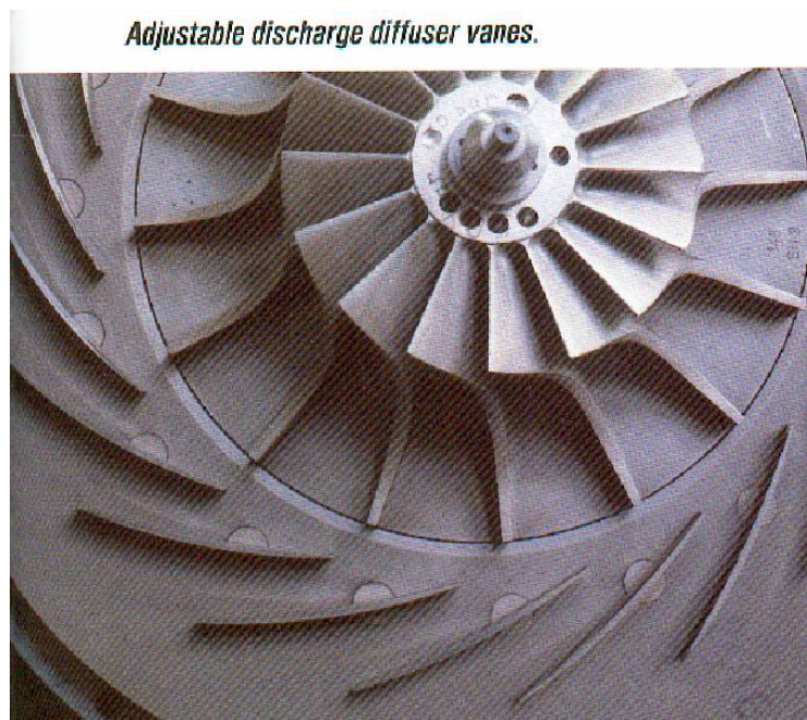
Figure II-11 Aubes orientables à la sortie d'un étage centrifuge
