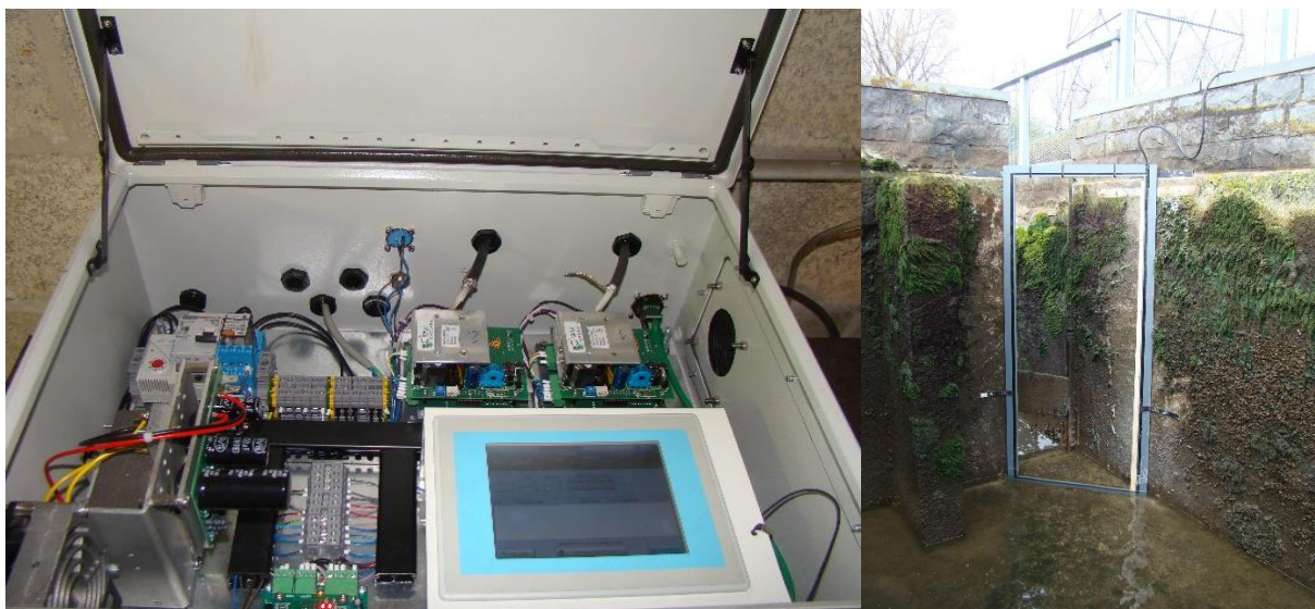
Fig.3 : Station d'enregistrement RFID automatique (à gauche) et antenne de détection (à droite)
