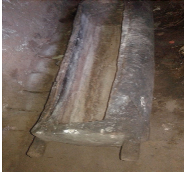
FIGURE 34: AUGES EN BOIS POUR EXTRAIRE LE JUS DE BANANE (PHOTO LARE)
