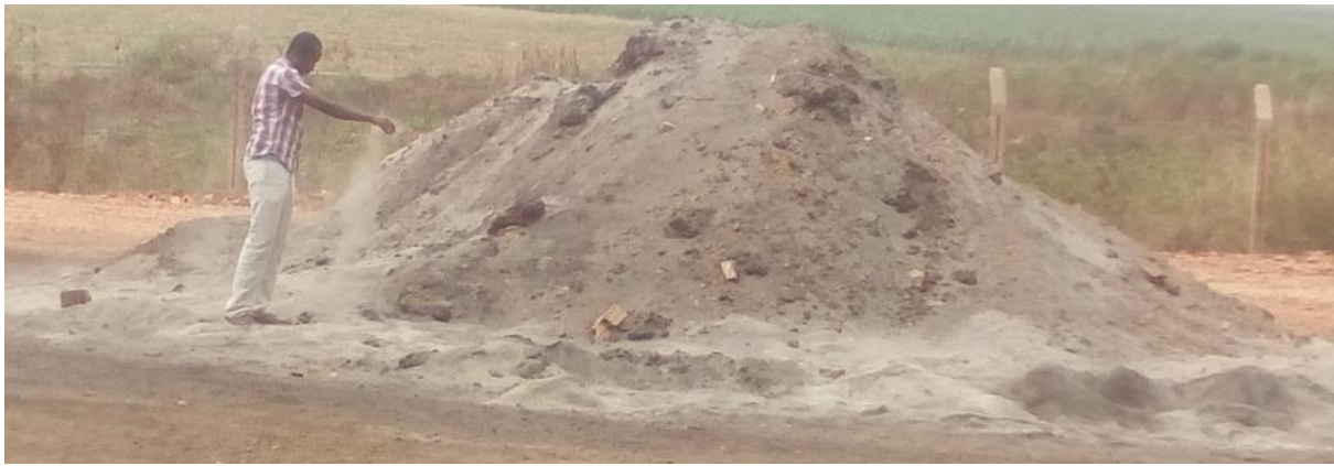
Fig. 93. Cendre de bagasse à la sortie du four.
