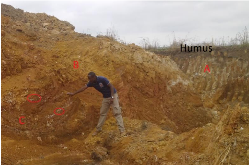
Fig. 98. Facies observés à la parcelle 406. A : « argile blanche ». B. niveau jaunâtre, C. niveau à taches rouges. Les cercles rouges montrent des niveaux qui contiennent des résidus de carbonates.
