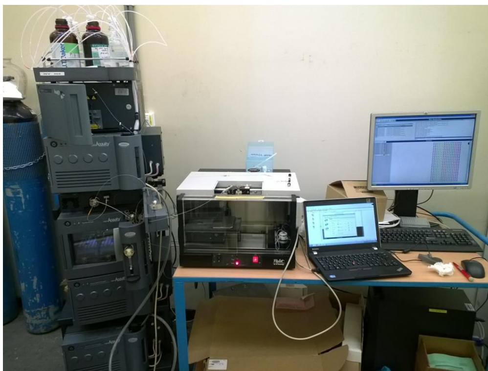
Figure 3 : Photographie du montage HPLC-Robot-MALDI (LSM - ULiège)
