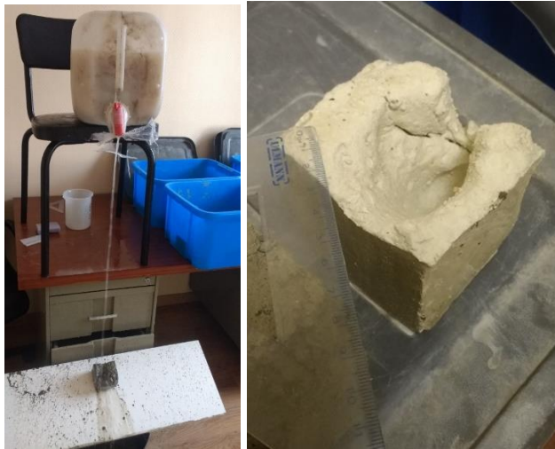
Fig. 33. Test d'égouttement accéléré (à gauche) et trou formé par l'égouttement accéléré (à droite).
