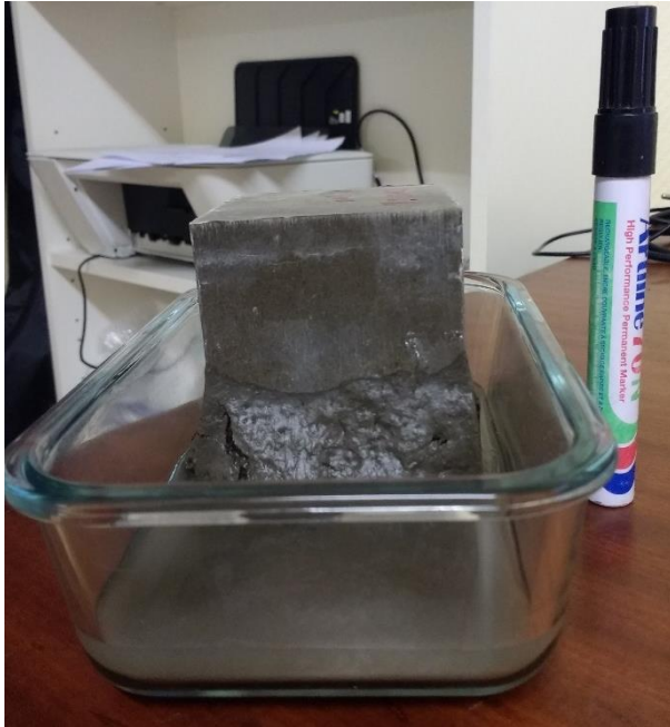
Fig. 32. Essai d'absorption d'eau par capillarité.
