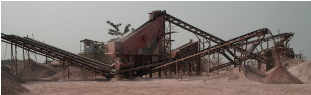
Fig. 18. Usine de concassage et broyage des grès de l'Inkisi.
