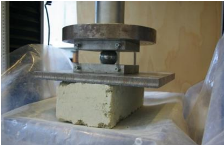
Fig. 27. Test de résistance à la compression.
