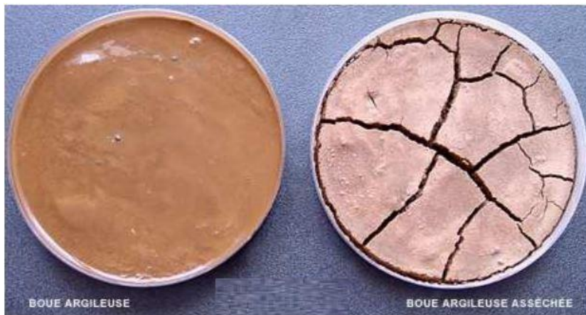
Fig. 21. Retrait de séchage d'une boue argileuse (Flament, 2013).
