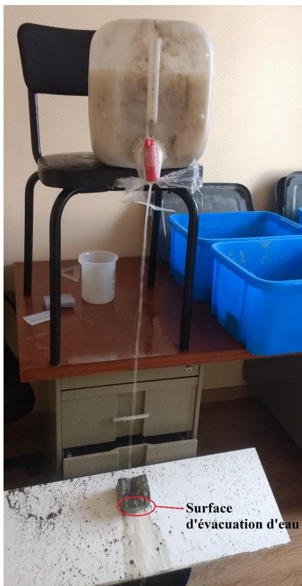
Fig. 117. Surface d'évacuation d'eau lors du test d'égouttement accéléré.
