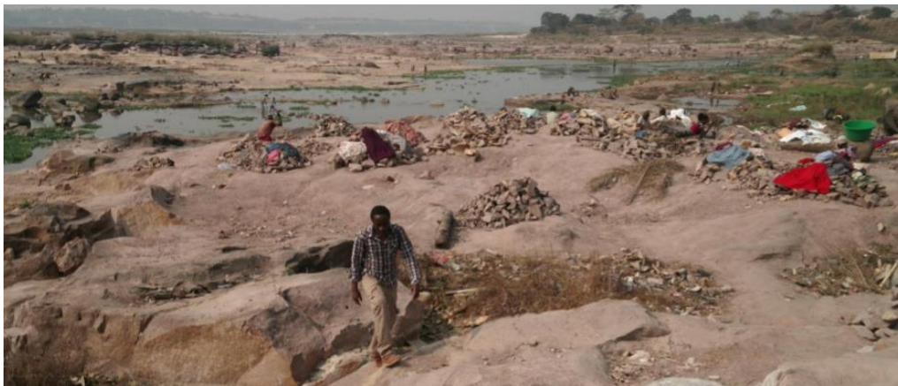
Fig. 19. Plaine du fleuve Congo. Zone d'extraction de sable et de concassage manuel du grès de l'Inkisi. Cette zone n'est accessible que durant la saison sèche, période de décrue.
