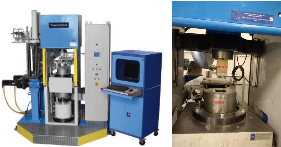
Fig. 25. Presse hydraulique utilisée (à gauche) ; Moule et piston de la presse hydraulique (à droite).
