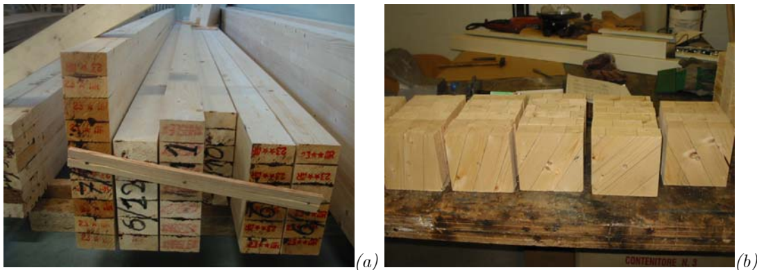
Figure 8-11 (a) Poutres en bois lamellé-collé utilisées pour l'ensemble des essais de compression et de flexion (b) Eprouvettes à faces carrées pour les essais de compression selon des angles variant de 0 à 90^\circ par rapport aux fibres.
