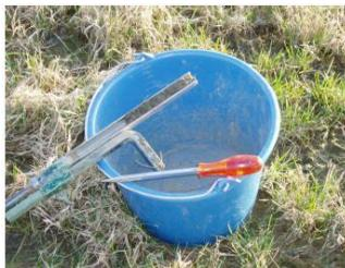
Seau en PEHD d'une contenance de 10 litres pour rassembler les échantillons élémentaires
