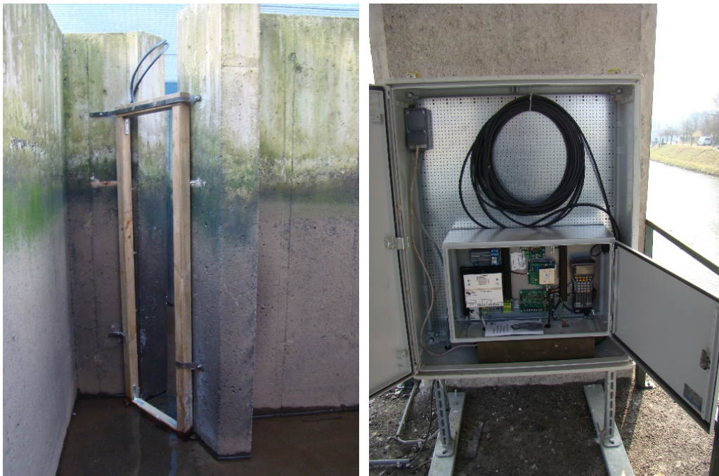
Figure 7. A gauche : antenne de détection RFID remplacée en 2015 au niveau d'une échancrure à l'amont de l'échelle à poissons du barrage des Grosses Battes sur la basse Ourthe à Liège nouvelle. A droite : station d'enregistrement des données installée dans une armoire métallique spécialement installée sur la pile du barrage.
