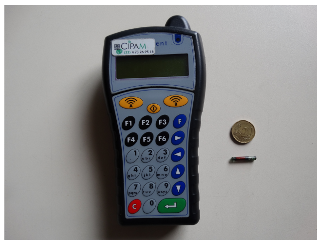
Figure 3. Transpondeur TIRIS (Texas Instrument) et lecteur de marque portable
