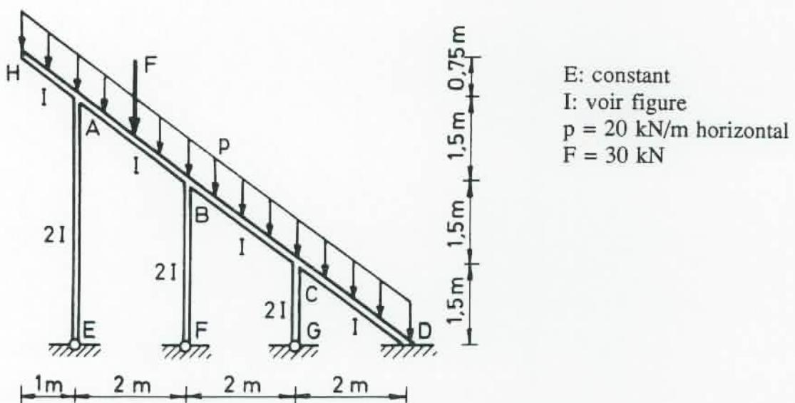
Déterminer les diagrammes des M, N et T et calculer les rotations des noeuds A, B et C.
