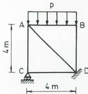
$$R : M_A(AB) = 3,217 \text{ tm} ; M_A(AC) = -1,783 \text{ tm} ; M_A(AD) = -1,432 \text{ tm} ;$$
