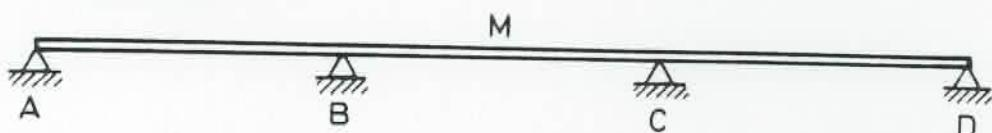
3. Dénivellation des appuis intermédiaires B et C, afin d'égaler en module les moments de flexion en B, M et C.
