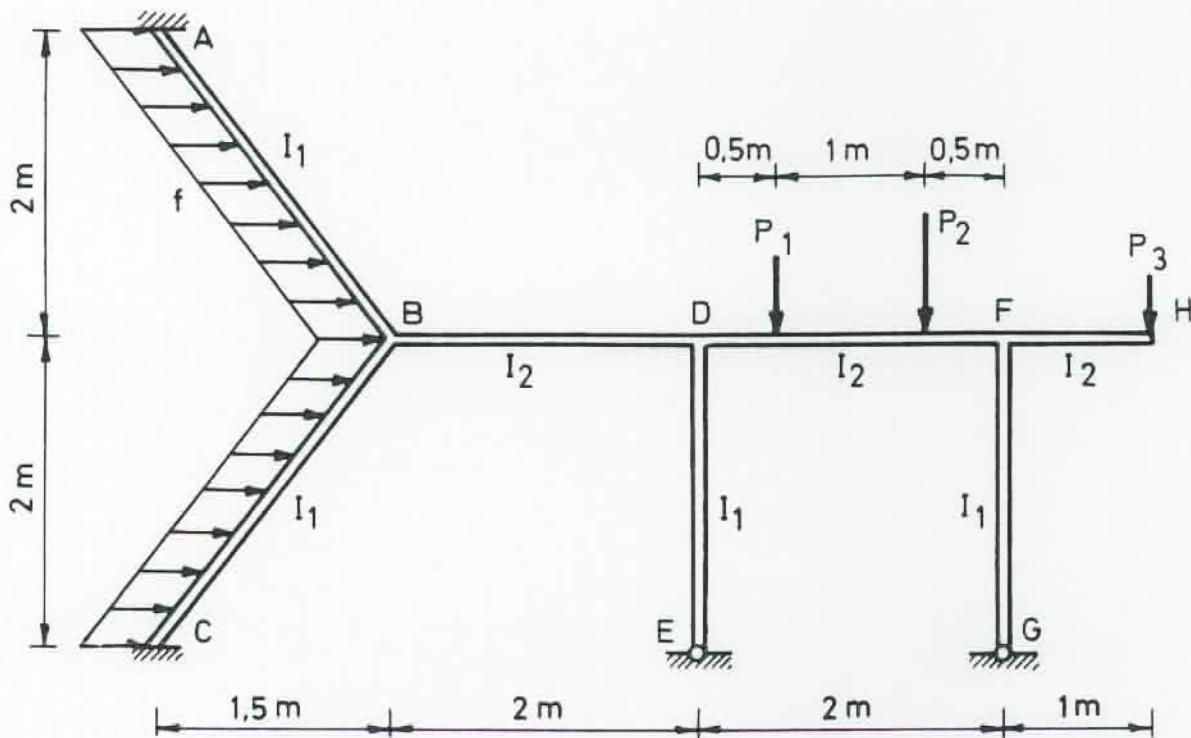
$$R : M_A = -0,73 \text{ kNm}; M_B(AB) = 1,07 \text{ kNm}; M_C = 0,95 \text{ kNm}; M_B(BC) = -0,61 \text{ kNm};$$
