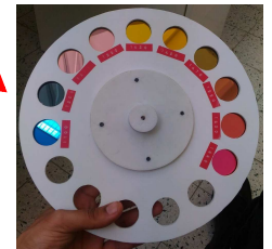
Figure 6 : Roue à 10 filtres optiques sur la gamme spectrale de 1100-1660nm : pas moyen de 80nm et une bande passante moyenne de 100nm.
