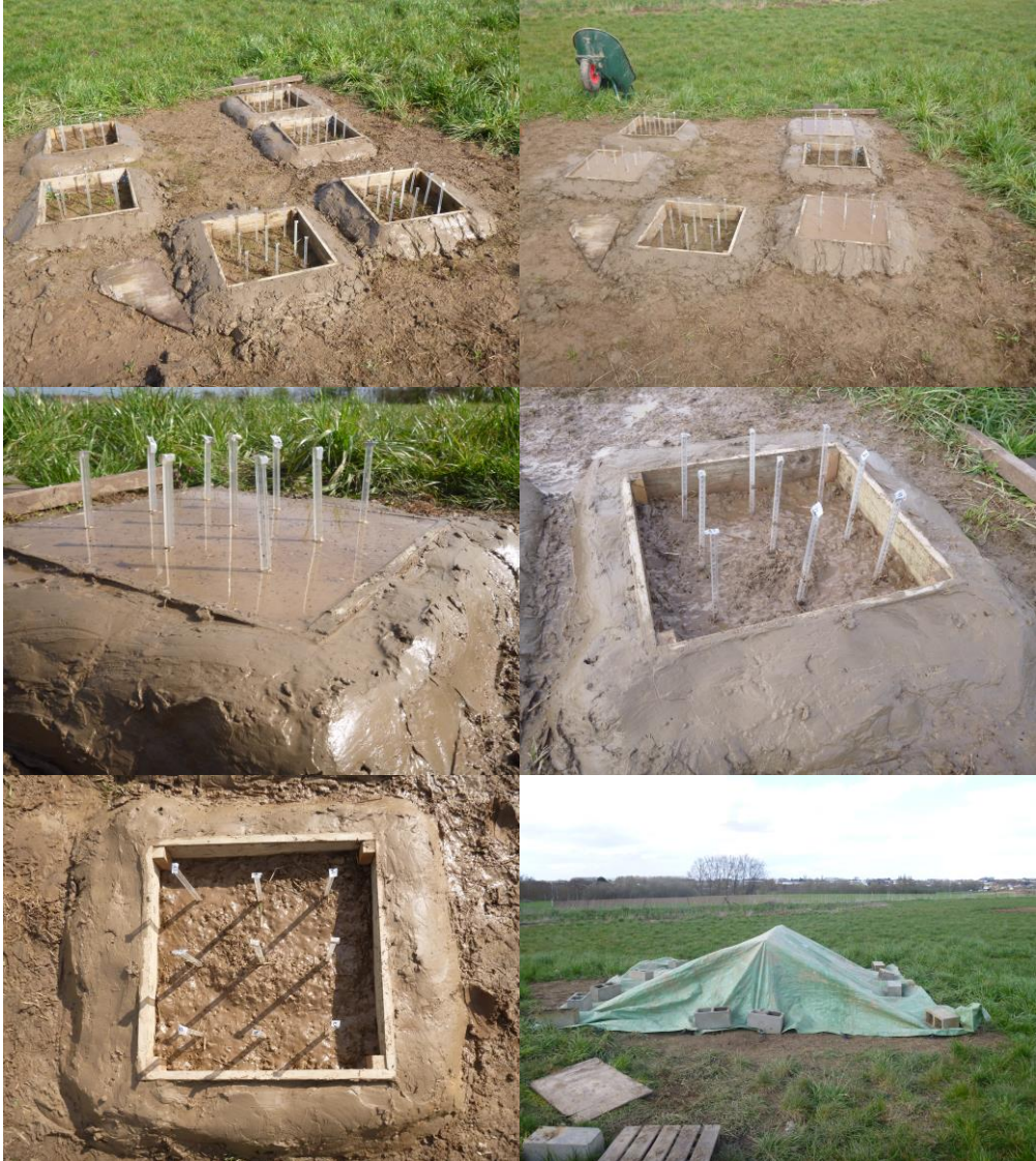
Figure- 13. Illustration des cadres en bois, remplissage des 50 g/L en premier, et évolution du cadre 1 en exemple et couverture des cadres.
