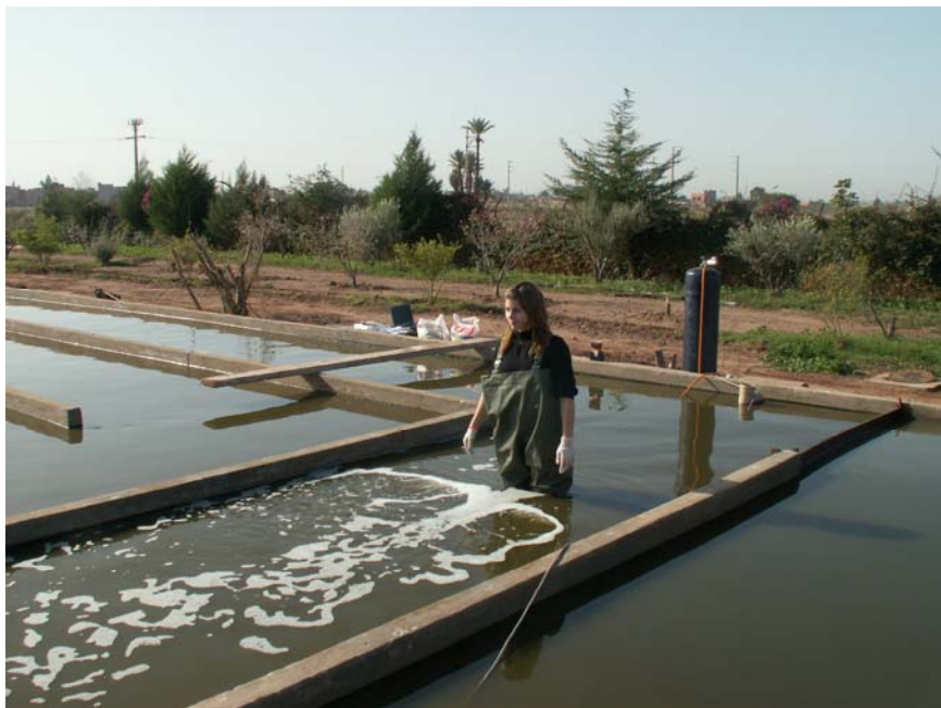
Photo 2. Injection du propane dans le chenal (essai avec la roue à aubes)
