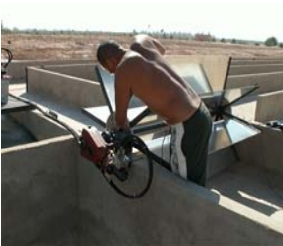
Photo 7. Groupe moteur hydraulique et moto réducteur avec raccords hydrauliques.
