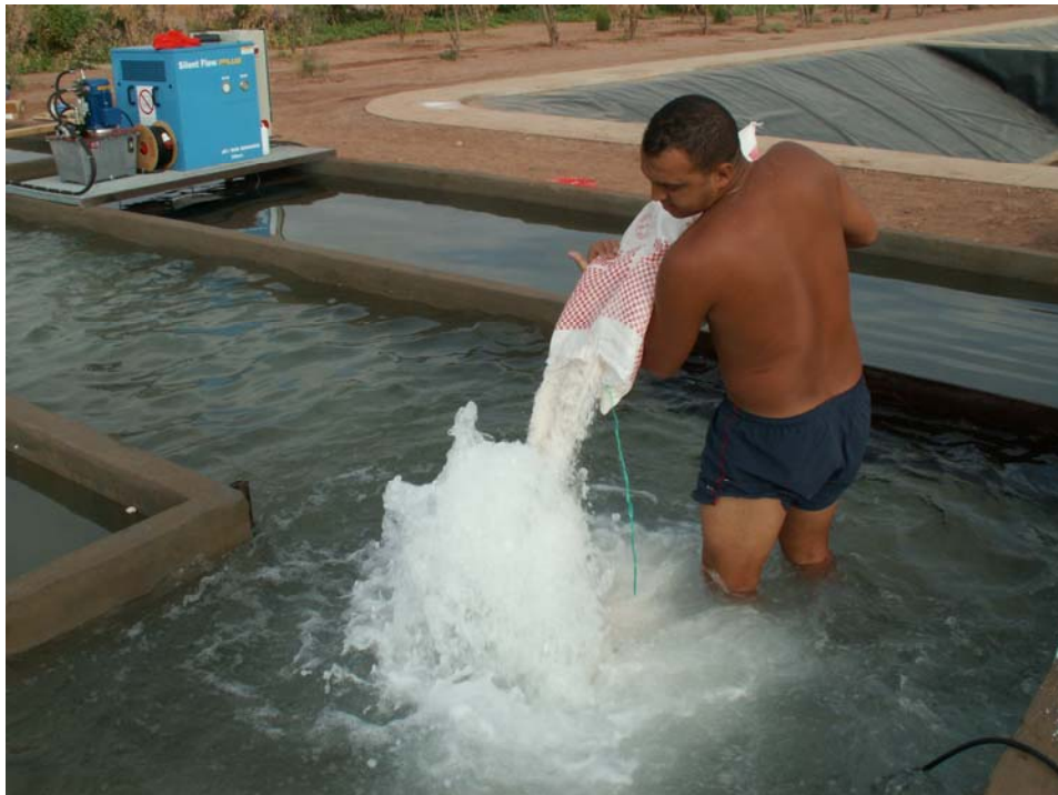
Photo 10. Injection de sel lors d'un essai de traçage avec la roue à aubes
