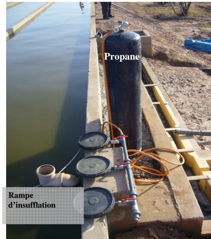
Photo 1 : Dispositif expérimental des essais au propane sur la station de Saada (Marrakech)
