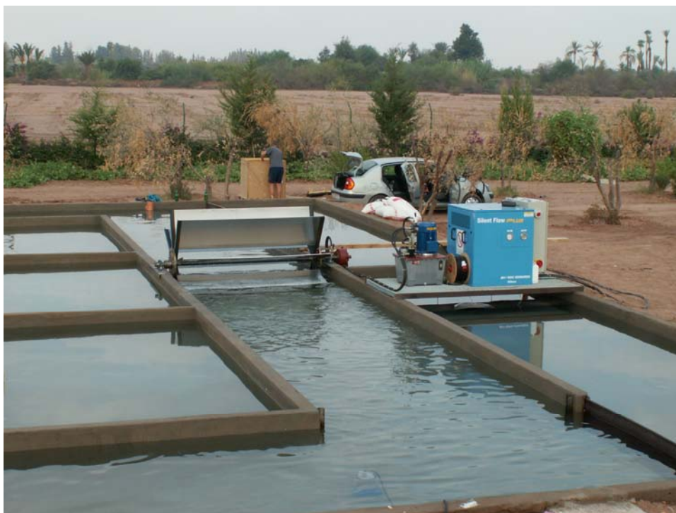
Photo 4. Le Chenal Algal à Haut Rendement de Saada avec ses deux systèmes d'agitation (Roue à aubes et Airlift)
