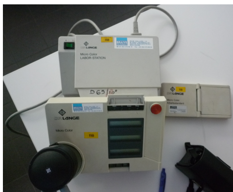
Figure 2-37. Colorimètre à filtres « Micro Color » de la marque Dr Lange ®, utilisé dans le cadre de notre recherche. L'appareil portable se compose d'un pavillon de mesure (contenant une sphère intégrative munie d'une lampe au Xénon), d'une unité de traitement où s'affichent les valeurs colorimétriques et d'un dispositif de calibrage.
