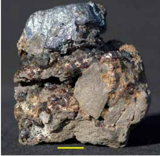
Fig. 47: Galène et sphalérite. Trait jaune = 1cm Coll et phot : F Van Troyen.
