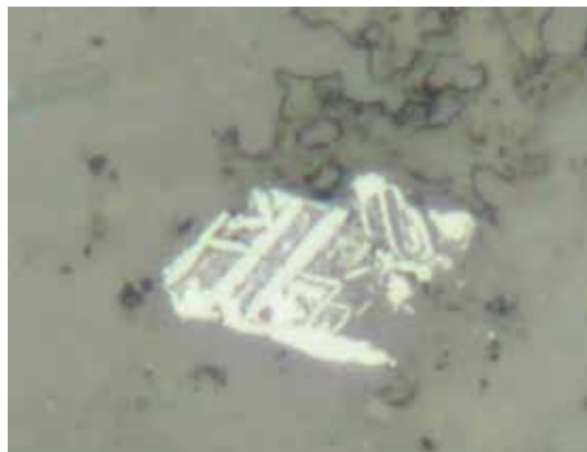
Figure 36: Rutile avec de nombreuses macles en genoux, photo en lumière réfléchie de l'échantillon LM2007-12 - grossissement 2000x.
