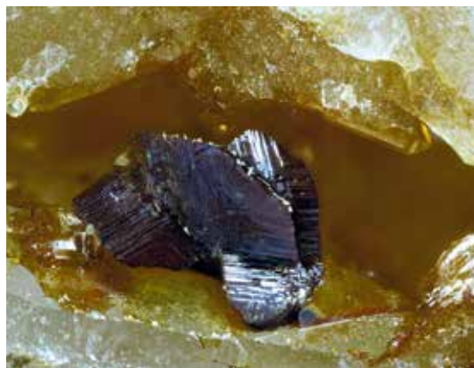
Figure 42: Lamelles brunâtres ondulantes (rhomboédres) de sidérite dans le quartz, photo G. Niceus, largeur de l'image 2,0 mm.
