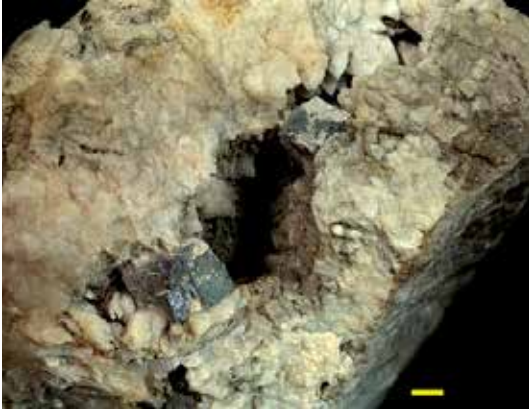
Fig. 94: Géode de calcite avec cristaux de galène et liseré de sphalérite au contact de l'éponte. Trait jaune = 1cm Coll et photo : G Ruelle.
