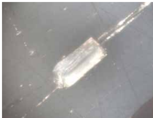
Figure 44: Cristal bien formé de zircon dans le minéral de stibine dans l'échantillon LMG349 (filon f2), vue au microscope pétrographique en lumière naturelle, grossissement 320x.
