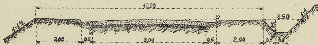
Fig. 6. Profil type de route départementale française.
