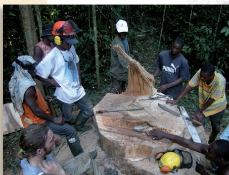
Abattage contrôlé – visualisation de la charnière et de la sécurité
