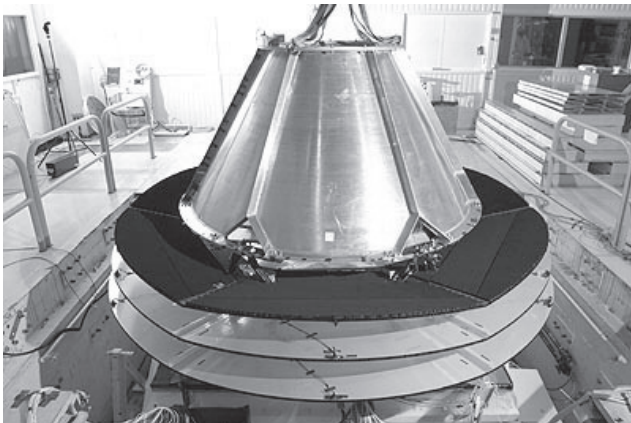
Les écrans de protection thermique en essai
