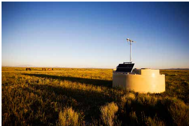
L'un des 1 600 détecteurs de l'observatoire Pierre Auger Ces détecteurs sont des cuves remplies de 12 tonnes d'eau pure, qui permettent de détecter les particules de la « gerbe atmosphérique », une cascade de particules secondaires produites lorsqu'un rayon cosmique entre dans l'atmosphère terrestre. En traversant les cuves d'eau, les particules secondaires produisent un flash de lumière par effet Tcherenkov. (Céline ANAYA-GAUTIER/ CNRS Photothèque)
