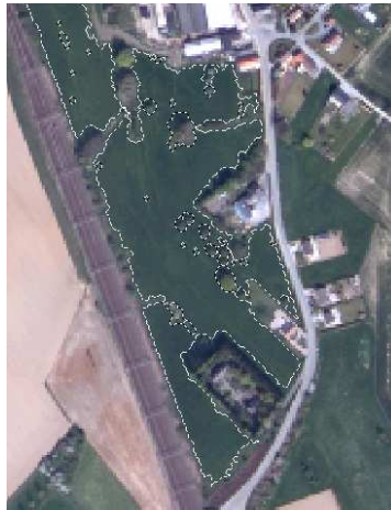
Figure 16. Délimitation d'une aire d'entraînement par 'Region Growing'. Seuls les pixels les plus proches de la valeur spectrale d'un pixel représentatif choisi sont pris en compte.
