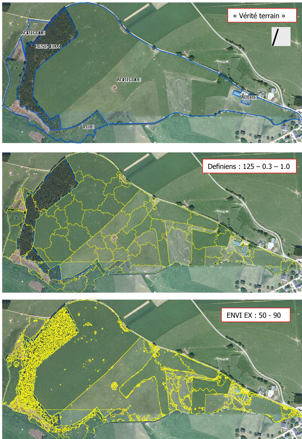
Figure 90. Ilot n°53453, vérité terrain et résultats des segmentation sur Definiens et Envi Ex.
