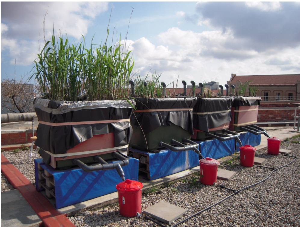
Figura 16. Planta pilot, s'observen els quatre llits amb els macròfits en diferents estats de desenvolupament, també s'observa el sistema de drenatge al fons de l'aiguamoll
