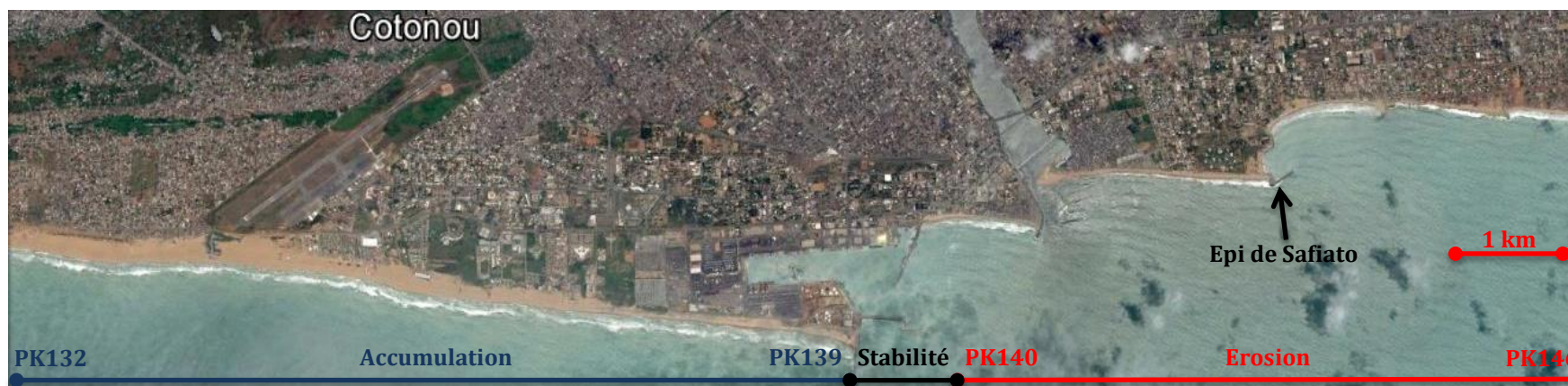
Figure 4 : Illustration du littoral actuel de Cotonou [Fig. 2, PK132 à PK146] (jadis linéaire avant la construction du port en eau profonde) avec profil en accumulation en amont (ouest) et en érosion en aval (est). Image Google Earth , 12 septembre 2015.
