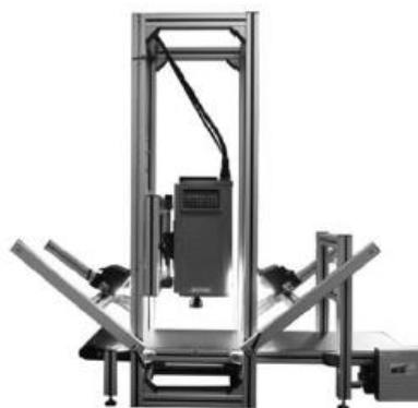
Figure 1 - Système d'acquisition des images hyperspectrales proche infrarouge (BurgerMetrics SIA, Riga, Lettonie). L'échantillon qui est éclairé par deux spots halogènes est posé sur une bande transporteuse et passe sous la caméra.
