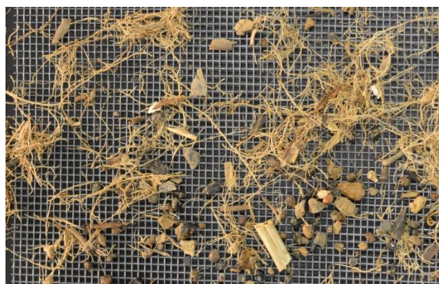
Figure 2 - Racines de froment, racines de pois, nodosités, fragments de pailles, particules de terre et cailloux extraits d'un échantillon de sol, étendus sur le grillage de support et posés sur le tapis de mesure de la caméra hyperspectrale proche infrarouge. Les éléments sont disposés de telle manière à éviter tant que possible qu'ils se recouvrent. Un spectre proche infrarouge va être acquis pour chaque pixel de l'image.
