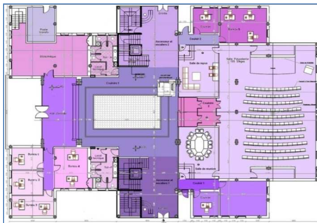
Figure 2: Zonage thermique du RDC du bâtiment
