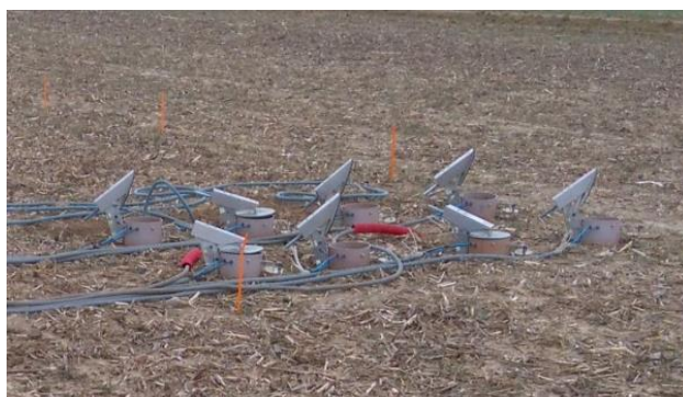
Figure 10.6 : Dispositif expérimental : ensemble de 8 chambres de sol sur la parcelle de froment d'hiver en labour réduit.
