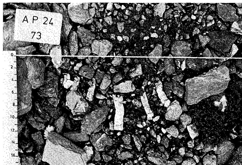
FIG. 11. — Photo d'un grand sol strié prise en 1973. En 1972, les bandes de papier d'étain visibles en surface ont été enfouies verticalement dans le sol à l'emplacement de la corde. Celle-ci est tendue perpendiculairement à la ligne de plus grande pente. En un an, ces bandes de papier d'étain sont donc sorties du sol d'une longueur qui atteint 6 cm et ont été déplacées dans le sens de la pente d'une distance qui varie de 6,5 cm au centre de la bande de matériel fin à 2,5 cm en bordure de celle-ci.
