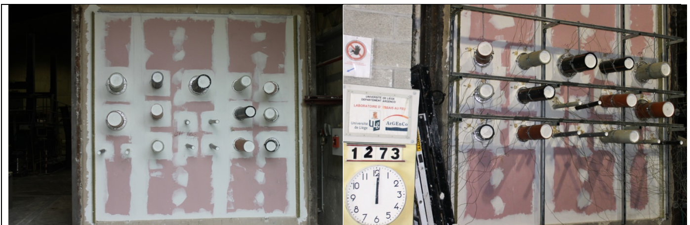
Calfeutrements de trémie montés dans une construction flexible avec deux bords libres verticaux
