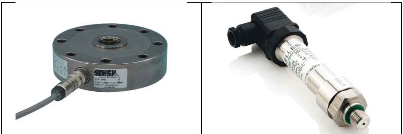
Exemples d'instruments utilisés : cellule de force et transmetteur de pression hydraulique (tous deux piezorésistifs)
