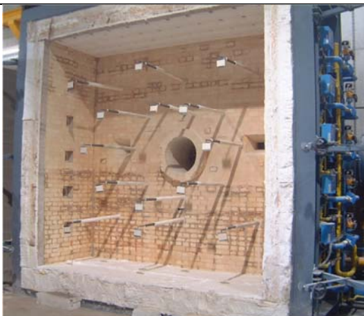
Four pour éléments d'essai verticaux Furnace for vertical test specimens
