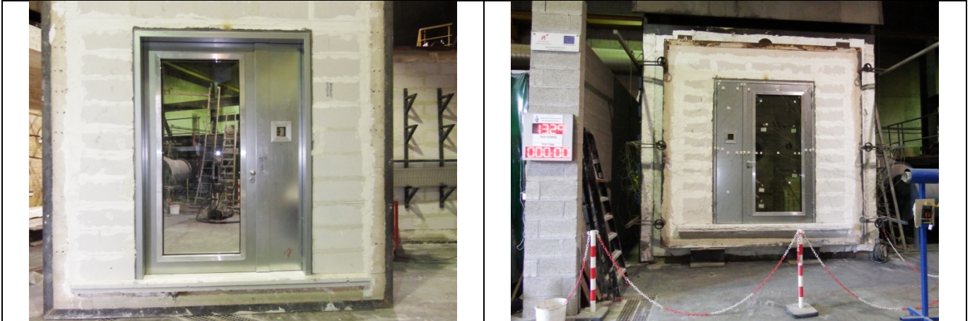
Porte montée dans une construction rigide à faible densité, elle-même montée dans un cadre d'essai Door mounted in a low density rigid construction, itself mounted in a test frame
