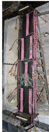
Colonne d'acier élancée enveloppée dans des nappes céramiques prêtes à être connectés Slender steel column wrapped in ceramic pads ready to be connected
