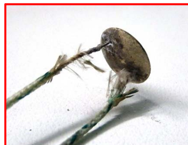
Thermocouple à disque et sa jonction de mesure
