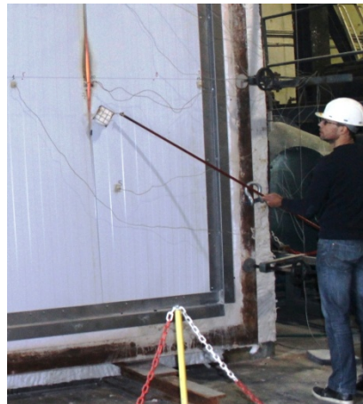
Application du tampon de coton près d'une ouverture Cotton pad test near an opening
