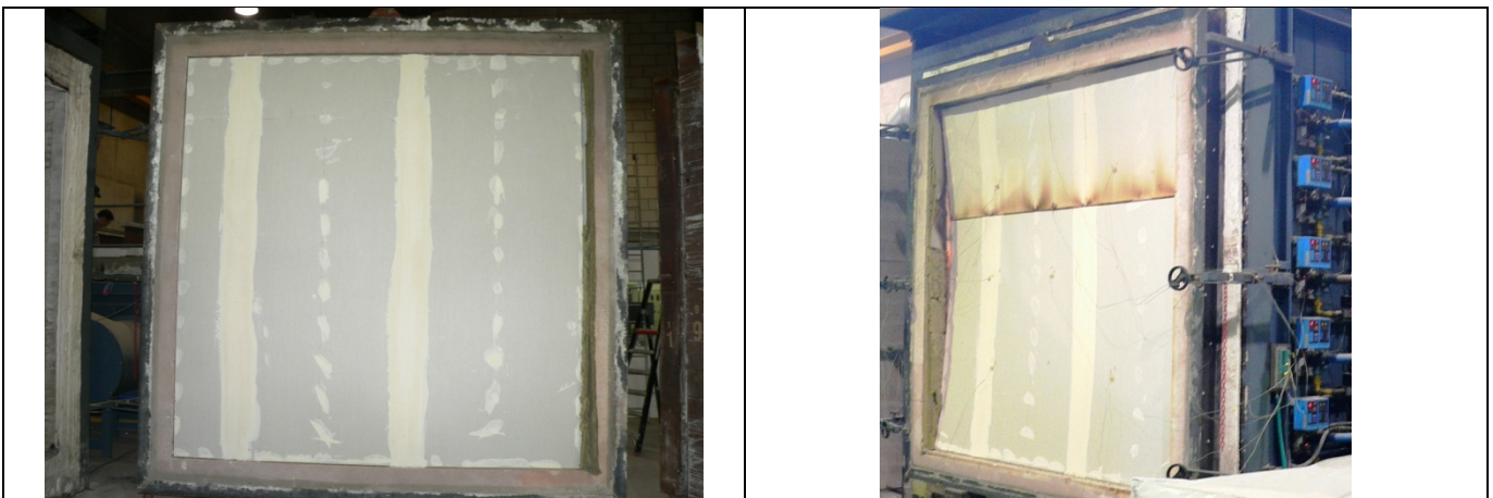
Cloison en plaques de plâtre montée dans un cadre d'essai avec un bord libre vertical Plasterboard partition mounted in a test frame with a vertical free edge
