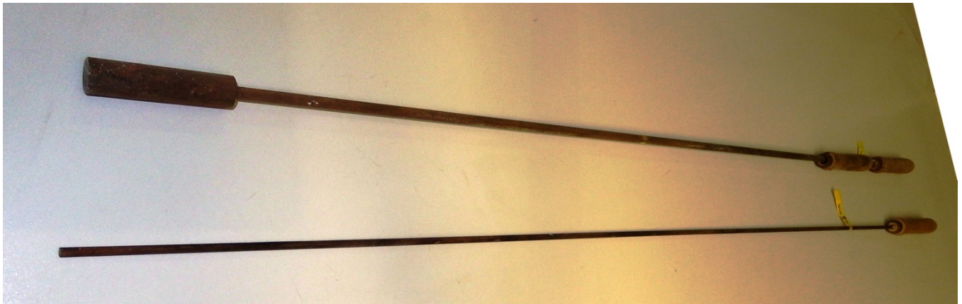
Calibres d'ouverture de \varnothing 6 et 25 mm Gap gauges of \varnothing 6 et 25 mm
