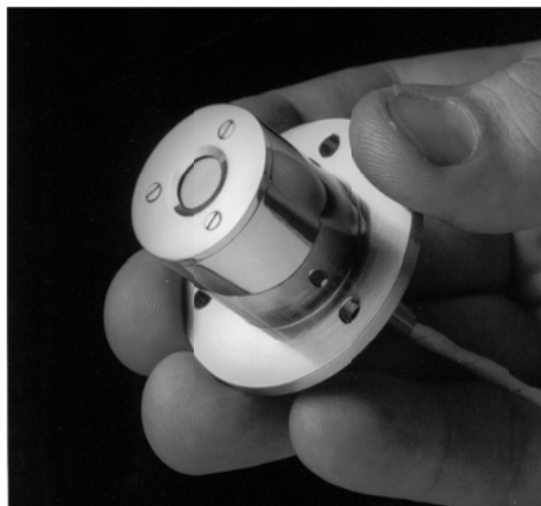
Capteur de rayonnement (type Schmidt-Boelter) utilisé en résistance au feu (gamme 0...50 kW/m 2 ) Heat flux transducer (Schmidt-Boelter type) used in fire testing (range 0...50 kW/m 2 )
