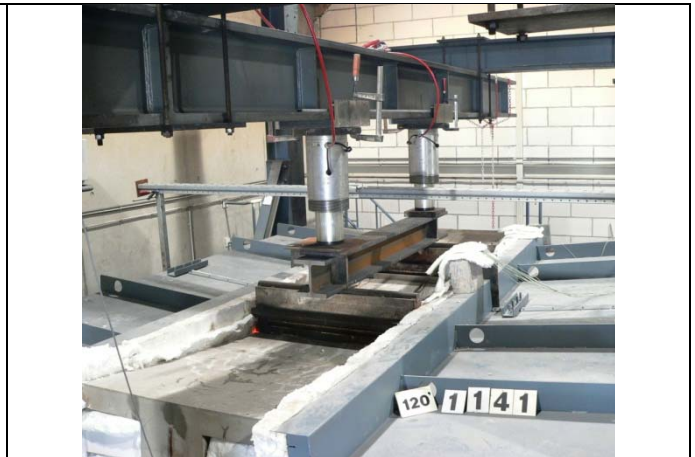
Matériel de chargement par vérins hydrauliques pour chargement en deux lignes sur four horizontal (capable de suivre une flèche de 200 mm) Loading equipment by hydraulic jacks for two lines loading on horizontal furnace (able to follow a deflection up to 200 mm)
