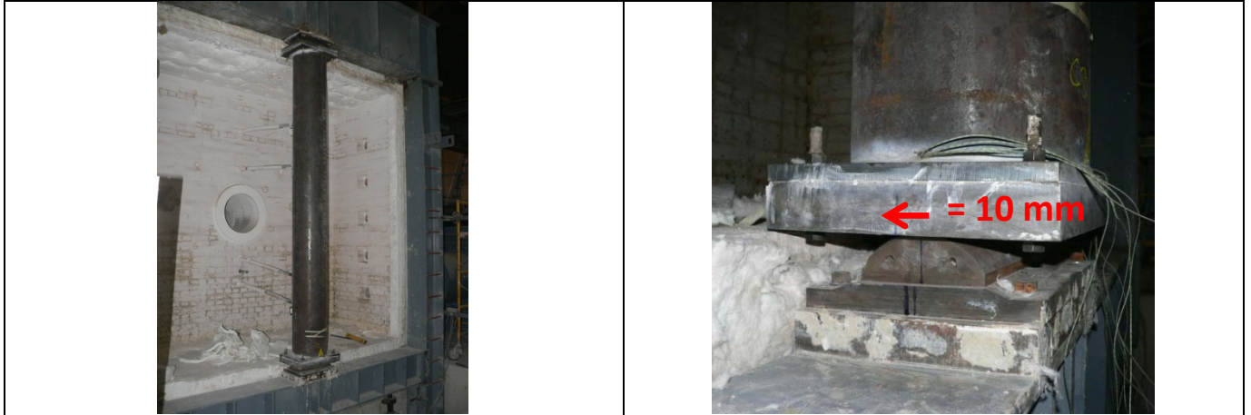
Poteau dans son cadre d'essai, détail de la rotule inférieure avec chargement excentrique (10 mm) Column in test frame, detail of the lower hinge with eccentric loading (10 mm)
