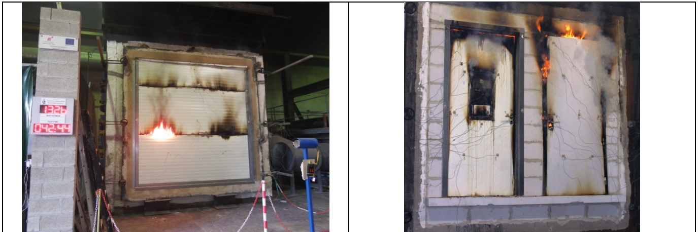
Inflammation soutenue sur une cloison (joint entre deux panneaux) et une porte (jeu huisserie-vantail) Sustained flaming on a wall (joint between two panels) and a door (gap frame-doorleaf)
