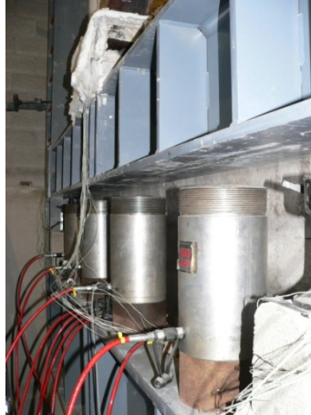
Matériel de chargement par vérins hydrauliques pour four vertical (4 vérins de 1000 kN) Loading equipment by hydraulic jacks for vertical furnace (4 jacks of 1000 kN)
