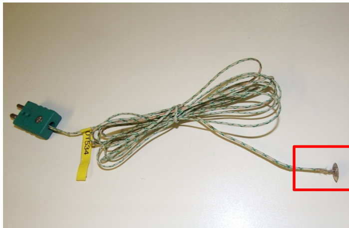
Thermocouple à disque et sa jonction de mesure
