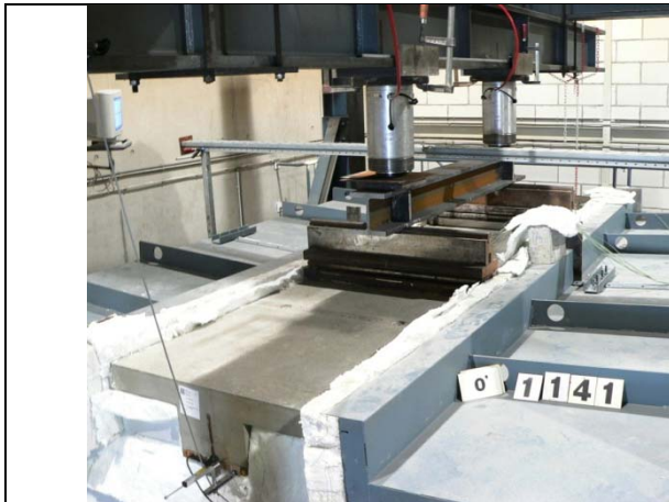
Matériel de chargement par vérins hydrauliques pour chargement en deux lignes sur four horizontal (capable de suivre une flèche de 200 mm) Loading equipment by hydraulic jacks for two lines loading on horizontal furnace (able to follow a deflection up to 200 mm)
