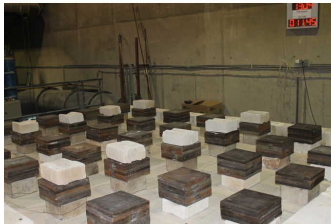
Chargement uniforme sur plancher Uniform loading on floor
