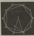
le triangle isoscèle AOB, l'angle à la base est double de l'angle au sommet. D'après cela, si nous menons la bissectrice BC, le triangle BCO sera isoscèle; et les triangles ABO, ACB, ayant un angle commun et un angle égal, seront semblables. Donc
