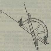
ensuite tourner le limbe, au moyen du genou et de la douille, jusqu'à ce que la ligne de foi DD' soit dirigée vers le signal B. On serre les vis de pression, de telle sorte que tout le graphomètre soit fixe. Faisant enfin tourner l'alidade mobile EE' jusqu'à ce que la ligne de visée passe par le signal C, on lit sur le limbe l'arc D'E', mesure de l'angle BAC.
