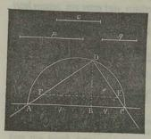
Prenons, sur une droite indéfinie, AB = p, BC = q; sur AC, comme diamètre, décrivons une demi-circonférence; élevons en B la perpendiculaire BD au diamètre; tirons les droites indéfinies DA, DC; prenons, sur celle-ci, DE = c; enfin, par le point E, tirons EF parallèle à CA. Je dis que DF est le côté du carré cherché.
