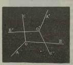
La première partie de la proposition vient d'être démontrée. Relativement à la seconde, il suffit d'observer que, d'après le théorème précédent, l'angle trièdre OABC a ses arêtes perpendiculaires aux faces de O'A'B'C'; donc les faces de OABC sont les suppléments des angles dièdres de O'A'B'C'.
