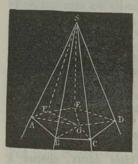
Coupons l'angle polyèdre par un plan qui rencontre toutes les faces: la section sera un polygone convexe ABCD... Prenons un point O dans l'intérieur de ce polygone, et menons les droites OA, OB,... Nous obtiendrons ainsi une série de triangles, en nombre égal à celui des faces de l'angle polyèdre, et dans lesquels la somme des angles qui se réunissent en O égale 4 droits.
