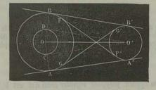
La même construction donne la seconde tangente extérieure BB'; et, en remplaçant la différence des rayons OA, OA' par leur somme, on obtient les deux tangentes intérieures FF', GG'\*.
