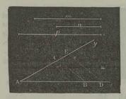
Sur les côtés d'un angle quelconque xAy, prenons AB = m, AC = n, AD = p; tirons BC, et menons, par le point D, la parallèle DE à BC. La droite AE sera évidemment la quatrième proportionnelle demandée.
