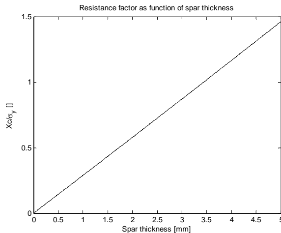
Figure 55-Evolution du facteur de résistance en fonction de l'épaisseur du longeron
