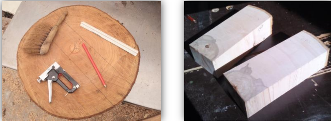
Figure 14. Découpe de deux barreaux de 12 cm de largeur le long d'un diamètre d'une rondelle.
