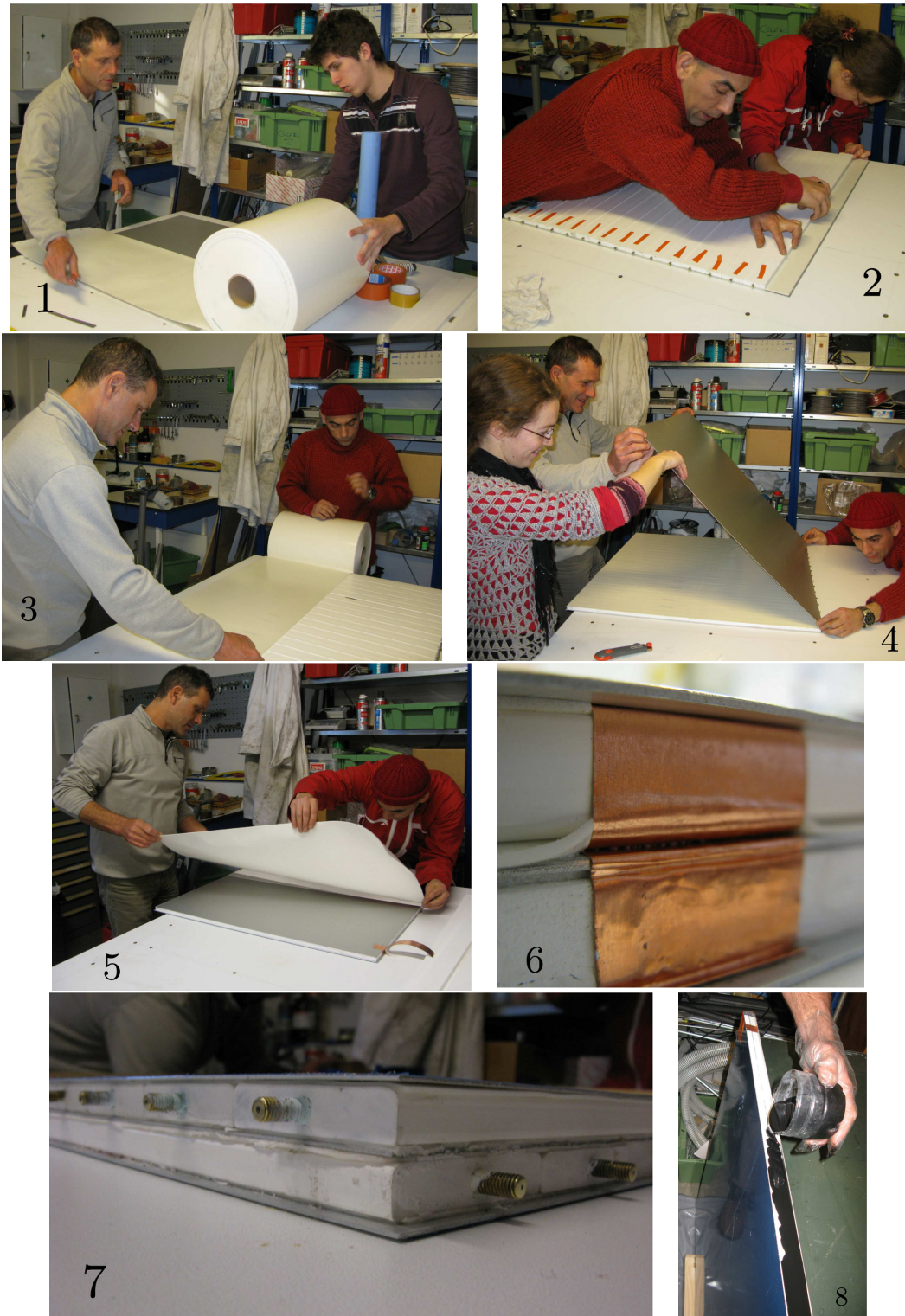
FIGURE 4.11 – Les barres de scintillateur sont fixées parallèlement sur une plaque d'aluminium avec du ruban adhésif (photos 1 et 2). Sur le premier plan est placée une seconde plaque d'aluminium (photos 3 et 4) sur laquelle repose le deuxième plan de scintillateurs (photo 5). Les trois plaques d'aluminium sont reliées au même potentiel avec un ruban adhésif en cuivre (photo 6). La troisième plaque d'aluminium est fixée sur le second plan (photo 7). La matrice est fermée avec de la résine noire pour éviter l'entrée de photons parasites (photo 8).
