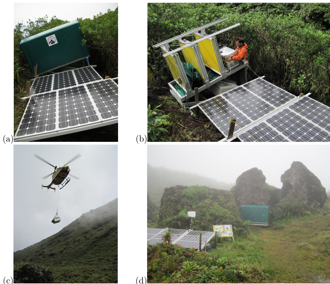
FIGURE 4.16 – MusTang a tout d’abord été installé au site de Ravine Sud au sud du dôme de la Soufrière, (a). Ce télescope possède trois plans de détection (b). Pour le transporter jusqu’au site du Rocher Fendu, il a fallu le faire hélitreuiller (c). MusTang est maintenant installé contre le Rocher Fendu, où l’antenne WiFi est en liaison directe avec l’observatoire. Les panneaux solaires sont orientés vers le sud et inclinés de 16^\circ (a,b,d).
