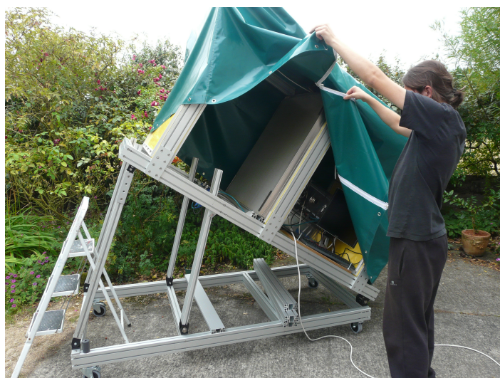
FIGURE C.1 – Le télescope RaCoon, incliné avec un angle zénithal de 57^\circ , en acquisition à Pont Péan. Les tôles sont installées juste devant la matrice milieu. Des jambes de force supplémentaires permettent au bâti de supporter les 400 kg ajoutés au poids des trois matrices de détection.
