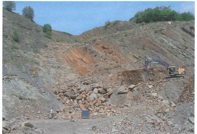
Fig. 20 – Front de taille de la carrière de Triffoy exploitant des grès famenniens (Formation d'Évieux) au moment où elle était active. Les couches inclinent vers le sud (photo E. Goemaere, 2006).
