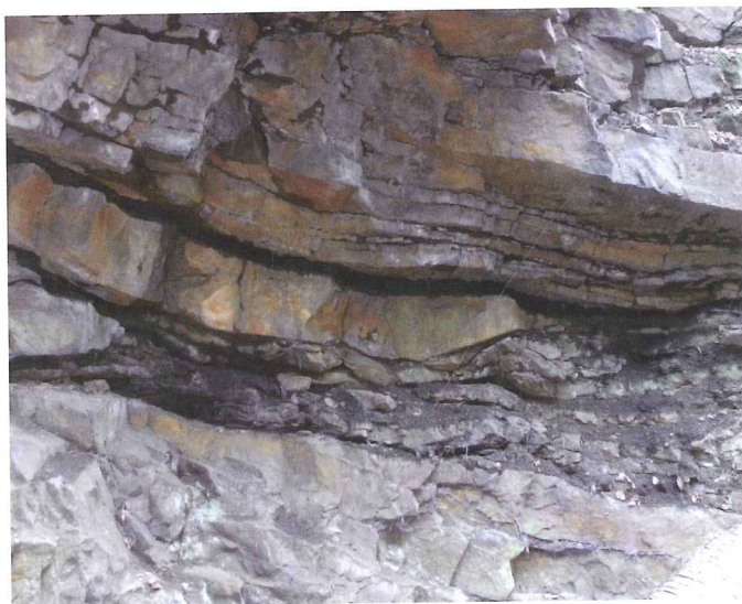
Fig. 11 – Bancs de grès namuriens entrelardés de veinules de charbon. Ancienne carrière du Bois des Dames, Andenne (photo E. Goemaere, 2010).
