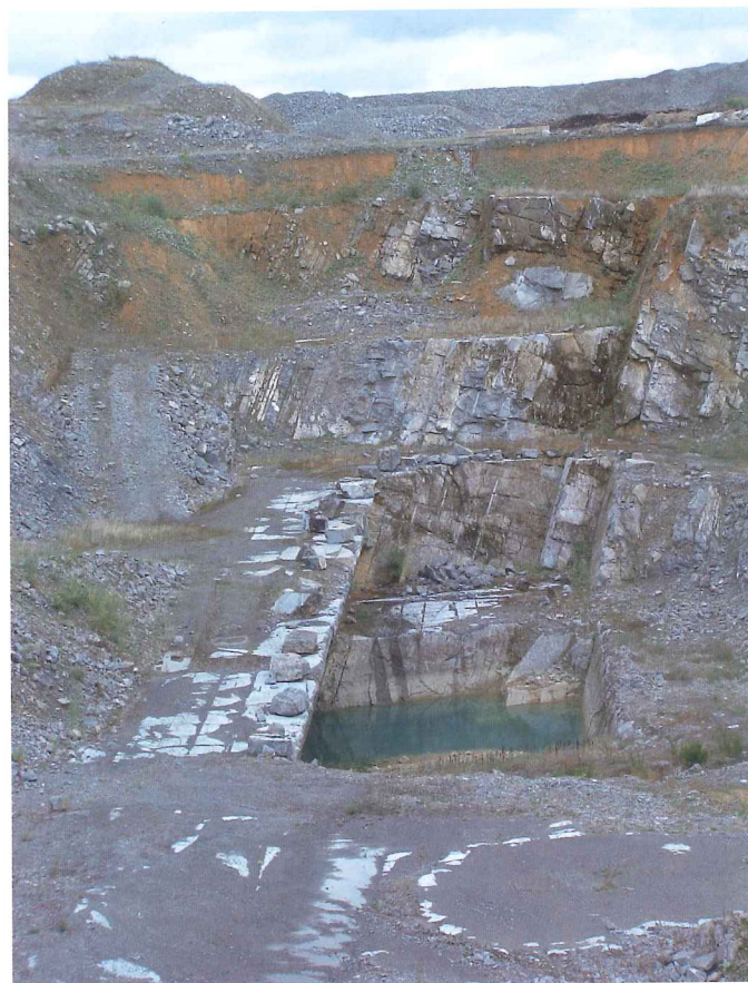
Fig. 16 – Vue ancienne d'une carrière condrusienne de Petit Granit dont les couches épaisses sont exploitées en demi-dressant. Les couches inclinent vers le sud. Les couches plus minces de la Formation de Martinrive sur la gauche de la photographie sont constituées de calcaire à chert (photo E. Goemaere, 2009).
