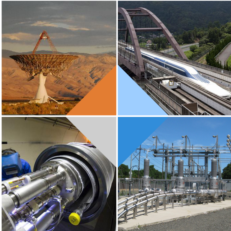
Figure 3 – Applications utilisant des supraconducteurs (dans le sens horloger, à partir du carré supérieur droit) : train à lévitation magnétique au Japon, ligne électrique supraconductrice aux USA, aimant supraconducteur au LHC et radiotélescope aux USA. Crédits : supraconductivite.fr .
