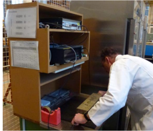
Figure 6-52 – Mesure du temps de transit de l'impulsion ultrasonique
