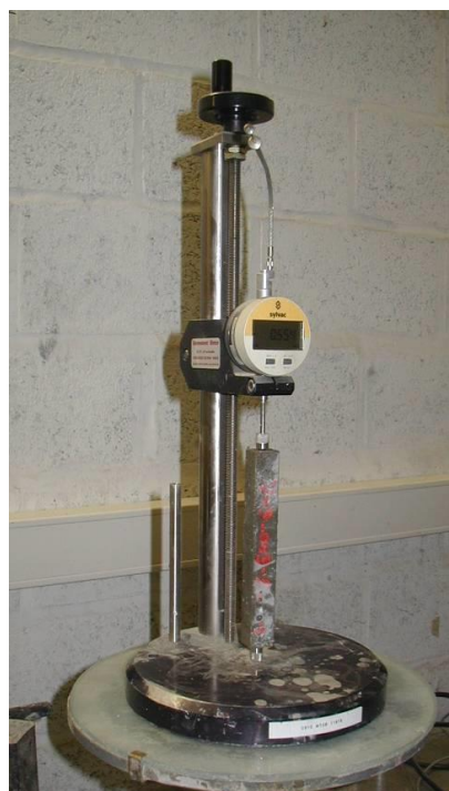
Figure 6-64 – Dispositif pour les mesures de gonflement
