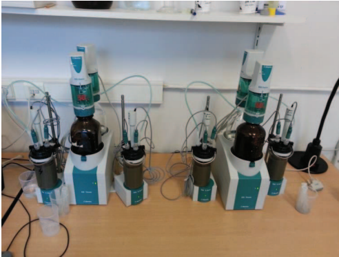
1) Dispositif de lixiviation des cendres volantes
