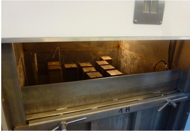
Figure 6-51 – Frigo de gel-dégel interne
