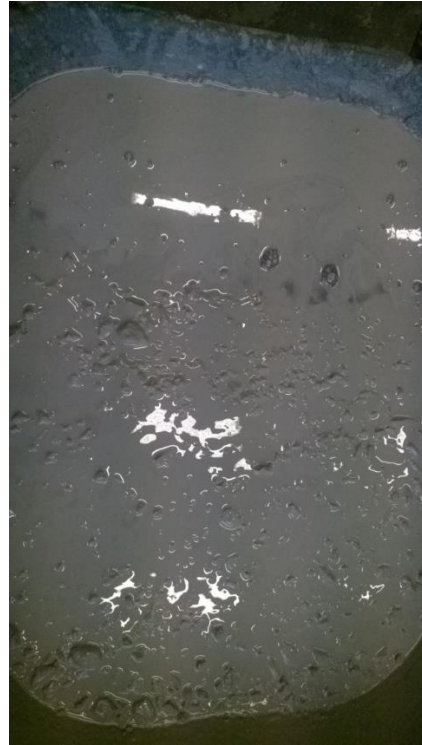
Figure 5-10 – Ségrégation du béton pour un dosage nominal en superplastifiant
