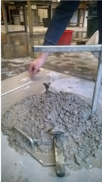
Figure 5-10 – Ségrégation du béton pour un dosage nominal en superplastifiant
