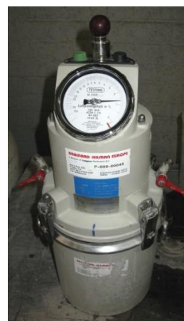
Figure 6-6 – Appareil de mesure de la teneur en air du béton frais
