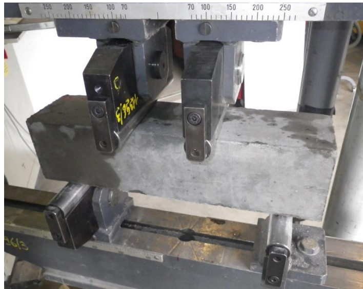
Figure 6-16 – Réalisation de l'essai de flexion en 4 points
