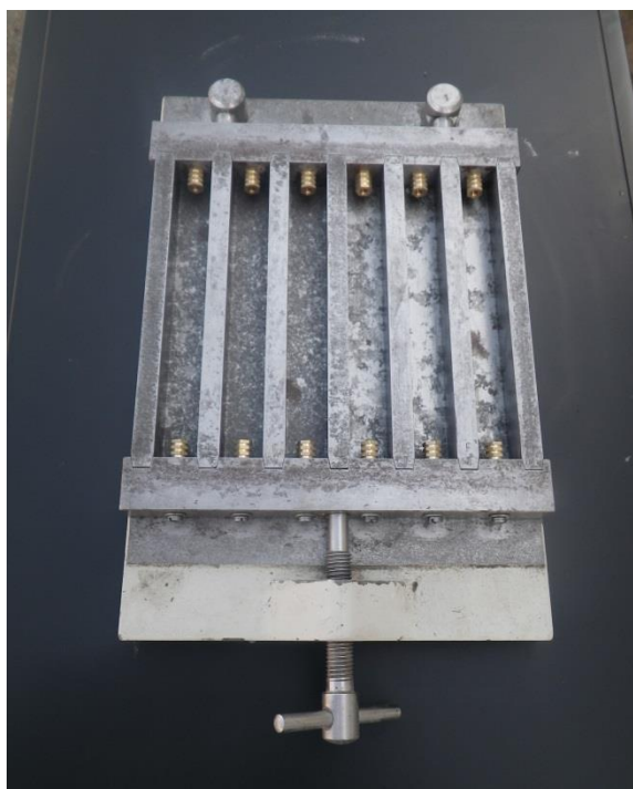
Figure 6-63 – Moules 2 x 2 x 16 cm 3 pour les essais de gonflement
