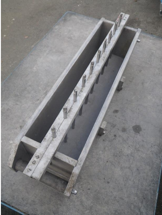
Figure 6-7 – Moule 15 x 15 x 60 cm 3 pour l'essai de prise Kelly-Bryant
