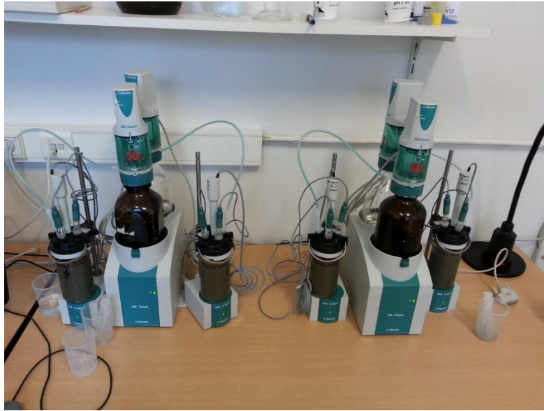
Figure 2-4 – Photographie du dispositif de lixiviation des cendres volantes
