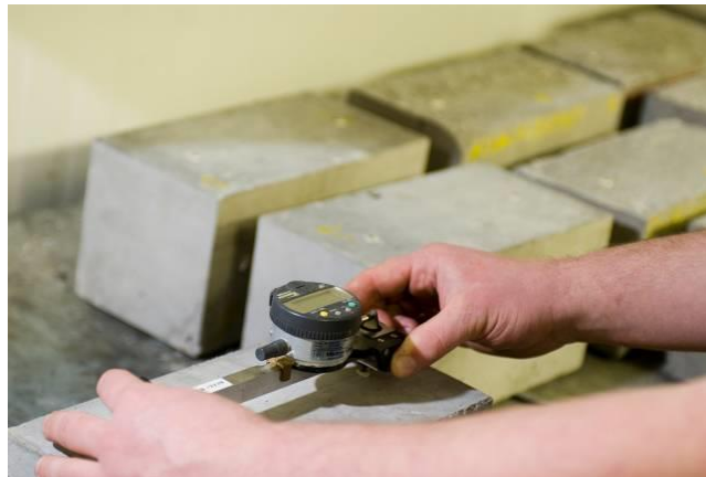
Figure 6-26 – Mesure du retrait
