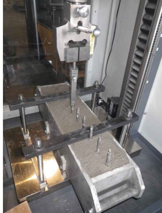
Figure 6-8 – Réalisation de l'essai de prise Kelly-Bryant
