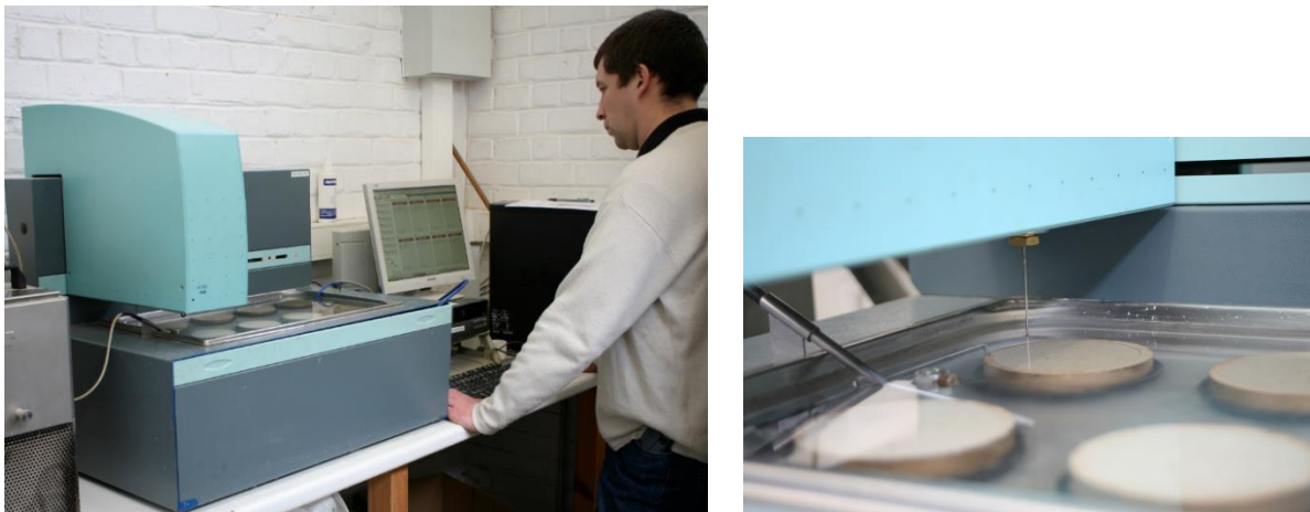
Figure 5-1 – Prisomètre automatique (appareil de Vicat)
