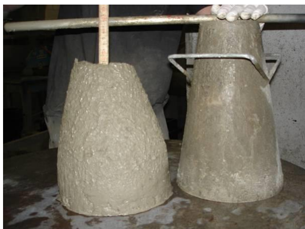
Figure 6-5 – Mesure de la consistance du béton frais par l'essai d'affaissement au cône d'Abrams
