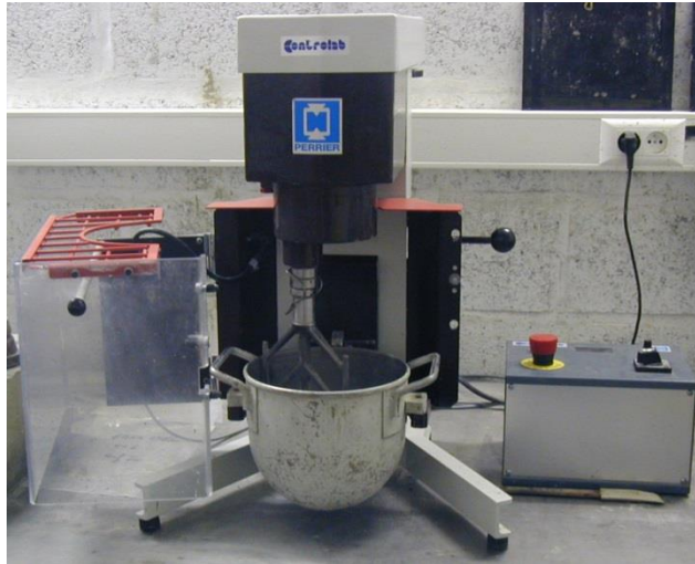
Figure 6-4 – Malaxeur CONTROLAB utilisé pour la confection des mortiers
