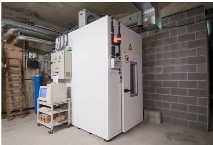
Figure 6-34 – Cellule pour l’essai de carbonatation accélérée
