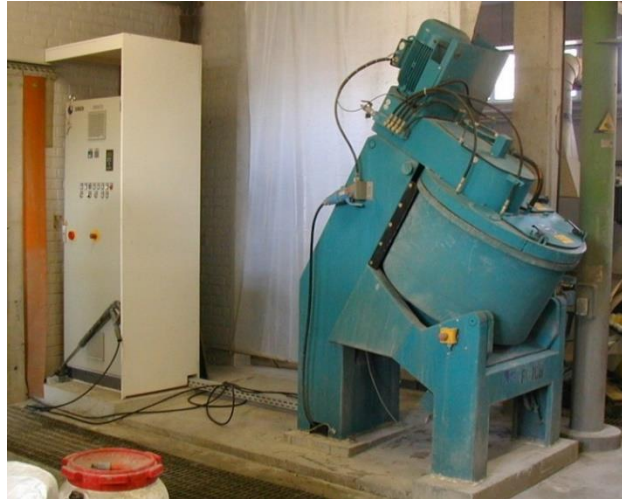
Figure 6-3 – Malaxeur EIRICH utilisé pour la confection des bétons
