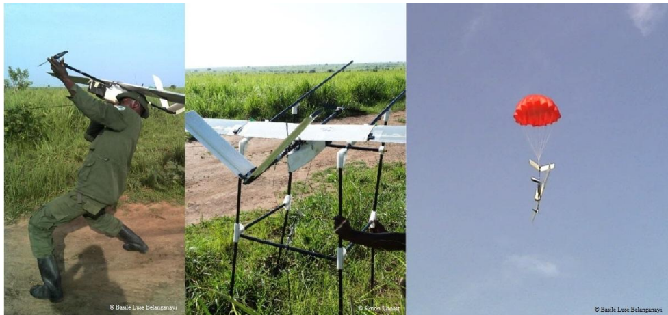
Figure 5 : A gauche et au centre, lancement du drone à la main et par une rampe de lancement, dans les deux cas avec la tension d'un élastique. A droite, atterrissage du drone par le déploiement du parachute.
