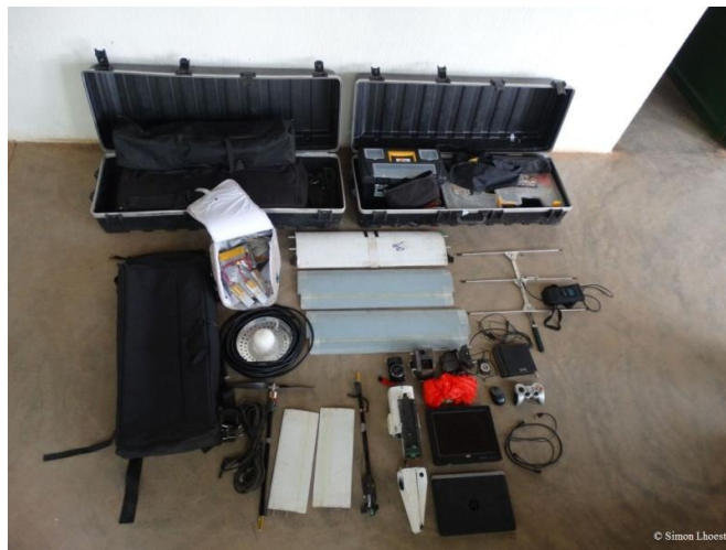
Figure 4 : Ensemble du matériel utilisé pour l'assemblage du drone Falcon Unmanned ©, son contrôle à distance et son entretien régulier.
