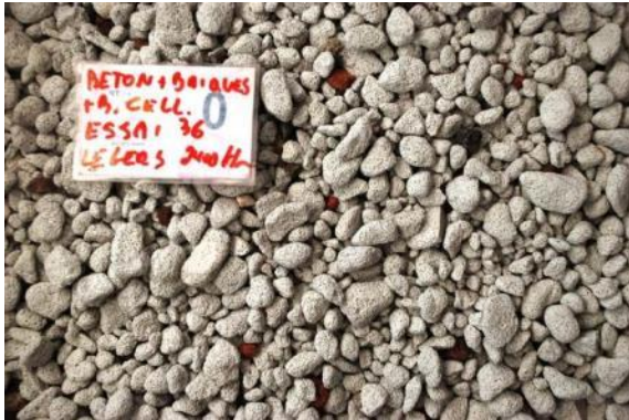
Figure 100 : Fractions récupérées par traitement gravimétrique à une vitesse d'entraînement du ventilateur de 2400 t/min de la fraction légère issue d'une première séparation gravimétrique de la fraction (4/16 mm) à une vitesse d'entraînement du ventilateur de 3000 t/min.
