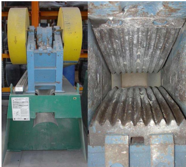
Figure 80 : Principe de fonctionnement du concasseur à mâchoires.
