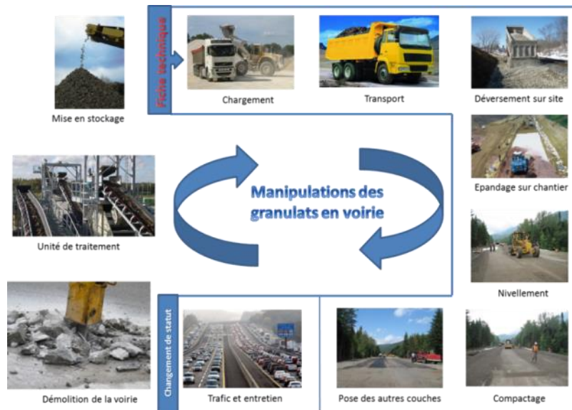
Figure 3 : Cycle des principales manipulations que subissent les granulats depuis l'unité de traitement jusqu'à la fin de l'exploitation de la voirie.
