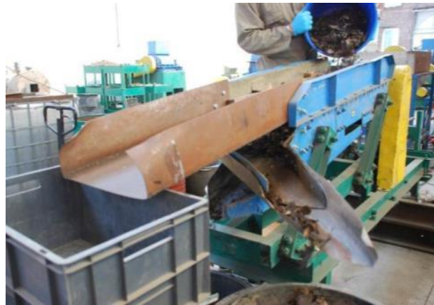
Photo 4 : Crible double étage.
