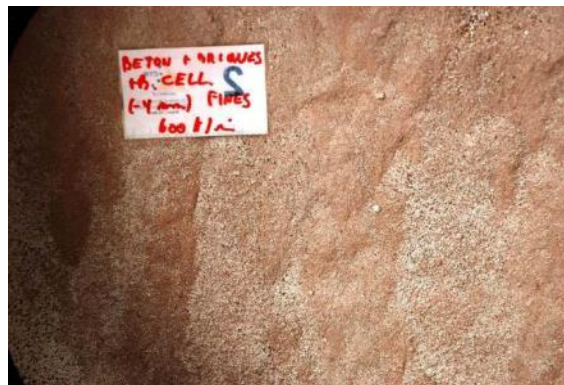
Figure 101 : Fractions récupérées par traitement gravimétrique de la fraction (0/4 mm) à une vitesse d'entraînement du ventilateur de 600 t/min.
