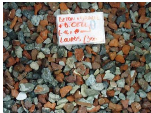
Figure 97 : Fractions récupérées après séparation gravimétrique de la fraction (10/16 mm).
