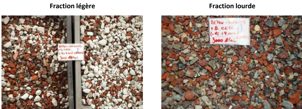
Figure 99 : Fractions récupérées par traitement gravimétrique de la fraction (4/16 mm) à une vitesse d'entraînement du ventilateur de 3000 t/min.
