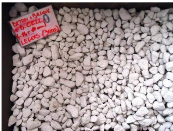
Figure 97 : Fractions récupérées après séparation gravimétrique de la fraction (10/16 mm).
