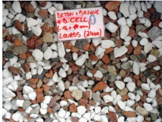
Figure 96 : Fraction lourde récupérée par traitement gravimétrique de la fraction (10/16 mm) à une vitesse d'entraînement du ventilateur de 2400 t/min.
