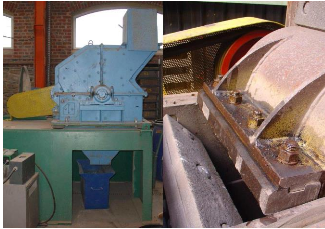
Figure 82 : Principe de fonctionnement du concasseur à percussion.
