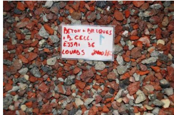
Figure 100 : Fractions récupérées par traitement gravimétrique à une vitesse d'entraînement du ventilateur de 2400 t/min de la fraction légère issue d'une première séparation gravimétrique de la fraction (4/16 mm) à une vitesse d'entraînement du ventilateur de 3000 t/min.
