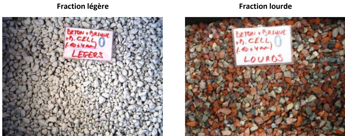
Figure 95 : Fractions récupérées après séparation gravimétrique de la fraction (4/10 mm).
