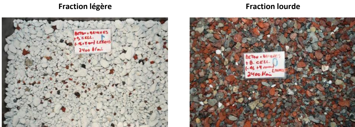
Figure 98 : Fractions récupérées par traitement gravimétrique de la fraction (4/16 mm) à une vitesse d'entraînement du ventilateur de 2400 t/min.
