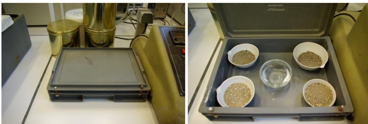
Figure 18 - Dispositif permettant la mesure de la demande en eau.
