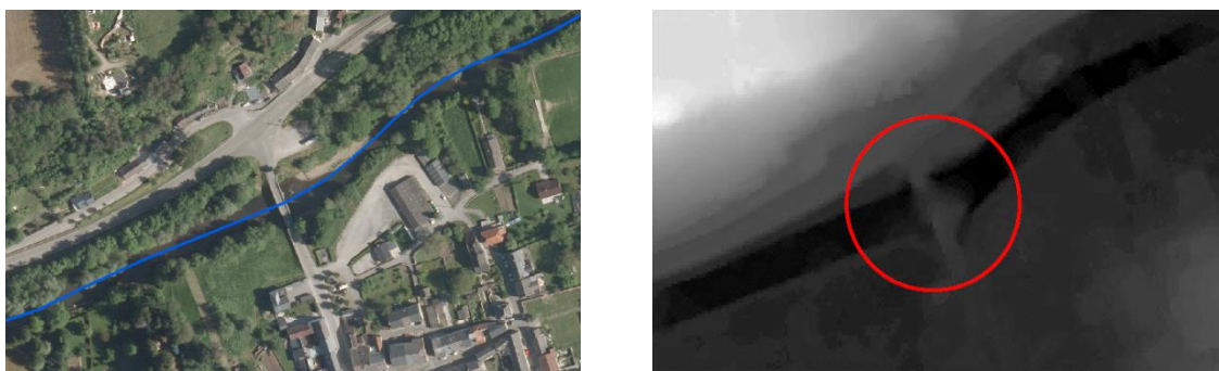
FIGURE 18 : "DIGUE" ARTIFICIELLE DANS LE MNT LIDAR - CAS DU VIROIN (OLLOY-SUR-VIROIN)
