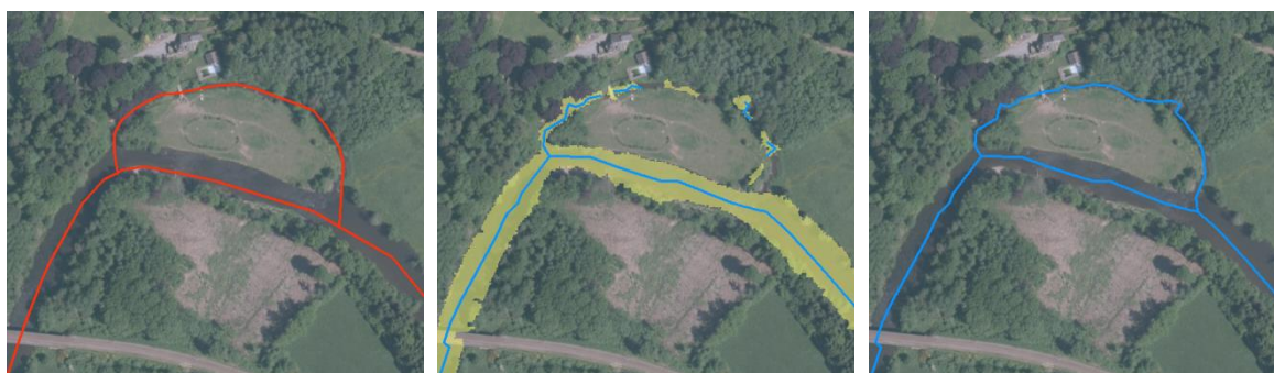
FIGURE 25 : VALLÉE DE L'AMBLÈVE À STOUMONT. DE GAUCHE À DROITE : ORTHO 2012 ET TRACÉ SCENIC ; SURFACE EN EAU LIDAR ET TRACÉ DÉRIVÉ ; TRACÉ CONTINU APRÈS PASSAGE EN POST PRODUCTION (ICI MODIFICATION MINEURE, INFÉRIEUR AU SEUIL DE 50M)
