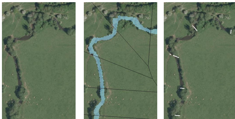
FIGURE 38 : EXTRACTION DE SECTIONS TRANSVERSALES DU LIT MINEUR (CALCUL D'UNE LARGEUR MÉDIANE) EXTRAIT DU JEU DE DONNÉE LIDAR
