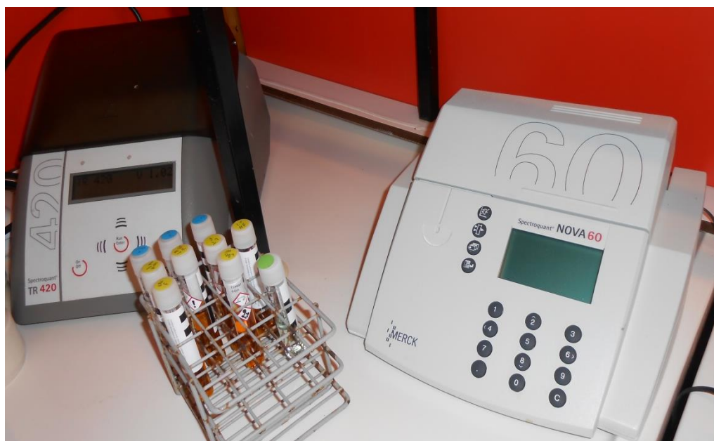
Figure 49. Appareils et réactifs utilisés pour la mesure de la DCO.
