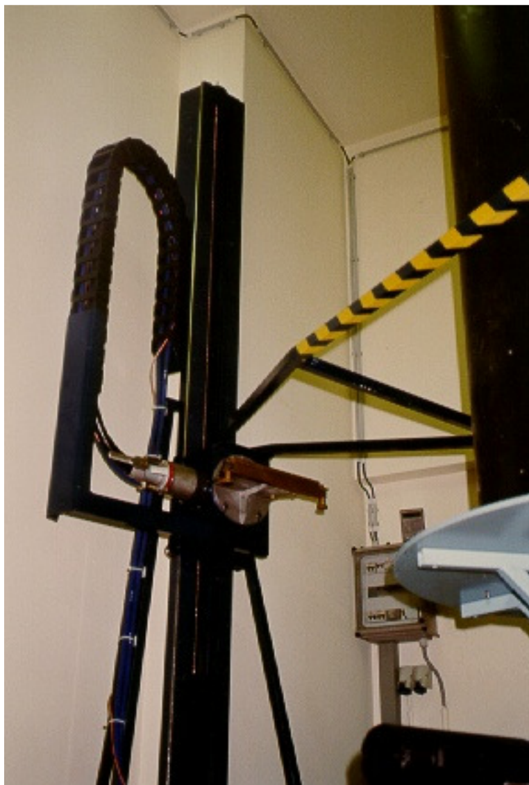
Figure A.III.1 : Photographie du tube R.X. et de son collimateur, montés sur un des montants verticaux du manipulateur.
