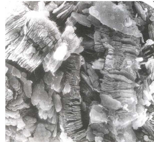
Plaquettes de kaolinite vues en microscopie électronique à balayage. http://www.espace-sciences.org
