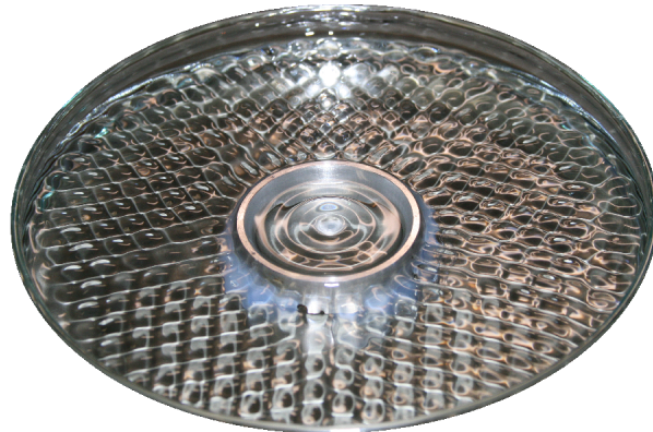
Figure 3.1 Instabilité de Faraday sur une surface d'huile silicone de faible viscosité (5 cSt). Le dispositif est constitué d'un petit cylindre ( r_c = 1.5 cm) et d'un grand cylindre ( r_c = 6.5 cm) concentriques.
