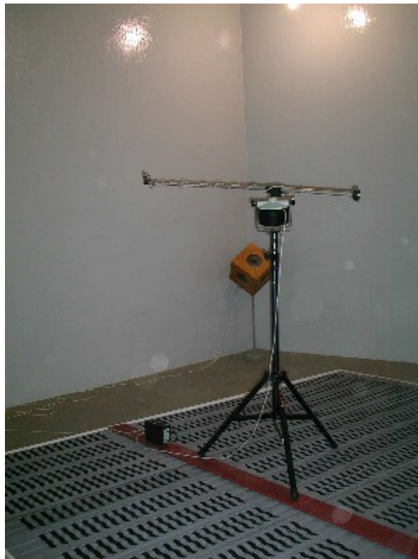
Figure 7b : Chambre réverbérante de l'institut Montefiore (Université de Liège), avec échantillon-test au sol.
