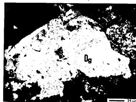
Bornite (Bn) formant des associations myrmékitiques avec la digénite (Dg). En haut, les plages bleues montrant des fentes de retrait sont constituées de yarrowite. Microscope polarisant en lumière réfléchie Moët-Fontaine - Cliché : F. Hatert
