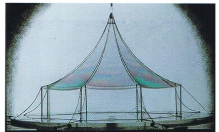
Fig. 32 - Machine à film de savon à l'Institut de Stuttgart : l'appareil photo permet de réaliser des clichés à partir desquels seront prélevées les mesures.
