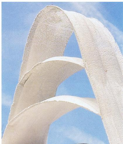
Fig. 34 - Modèle avec bandes de plâtre construit en suspension et inversé une fois sec
