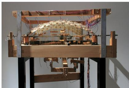
Fig. 37 - Maquette renforcée en époxy d'une pompe à essence, Heinz Isler, Deitingen, Suisse, 1967
